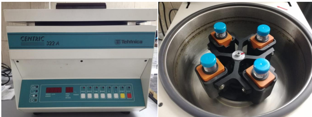
Slika 16. Prikaz centrifuge Tehnica 322 A i kiveta s uzorcima postavljenih u uređaj
