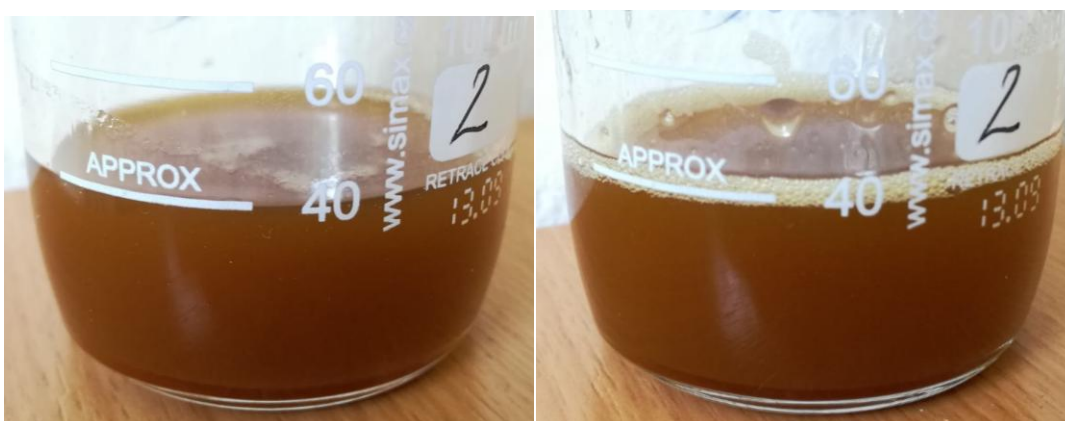
Slika 15. Prikaz smjese adsorbensa i masti prije (lijevo) i nakon (desno) adsorpcije
