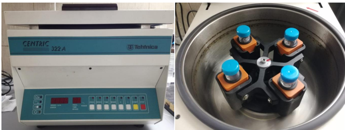
Slika 16. Prikaz centrifuge Tehnica 322 A i kiveta s uzorcima postavljenih u uređaj
