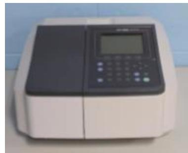
**Slika 3.3** UV-VIS spektrofotometar *Shimadzu UV-1800*
