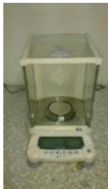
**Slika 3.1** Analitička vaga *Shimadzu*
