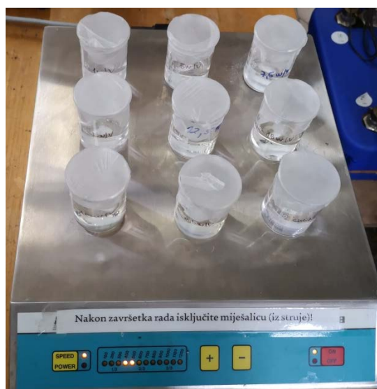
Slika 4.6. Fotografija uzorka LRS HCl u otopini pufera s odgovarajućim polimerom na magnetskoj miješalici
