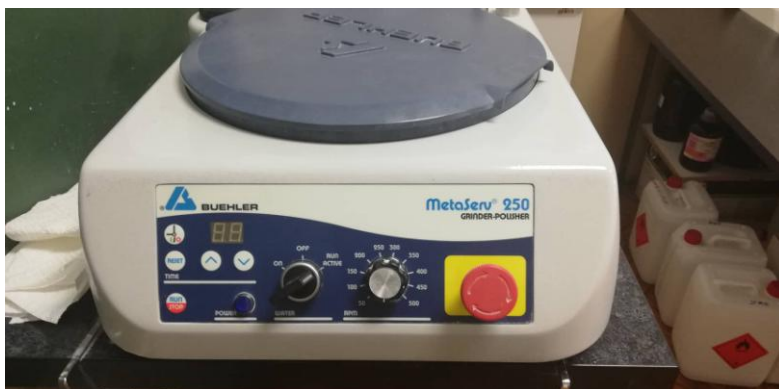
Slika 7. Uređaj za poliranje
