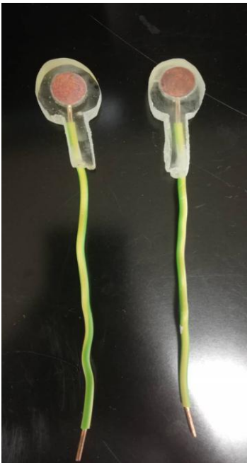
Slika 6. Prikaz radnih elektroda
