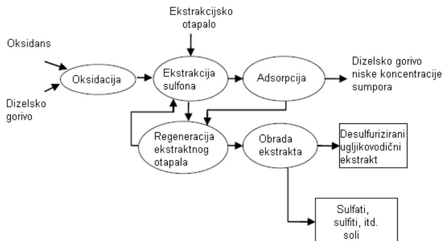
**Slika 3.** Pojednostavljeni dijagram CED tehnologije<sup>11</sup>
