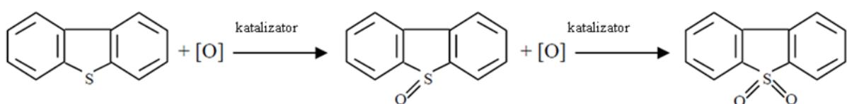
**Slika 2.** Reakcija oksidacije dibenzotiofena u sulfokside i sulfone
