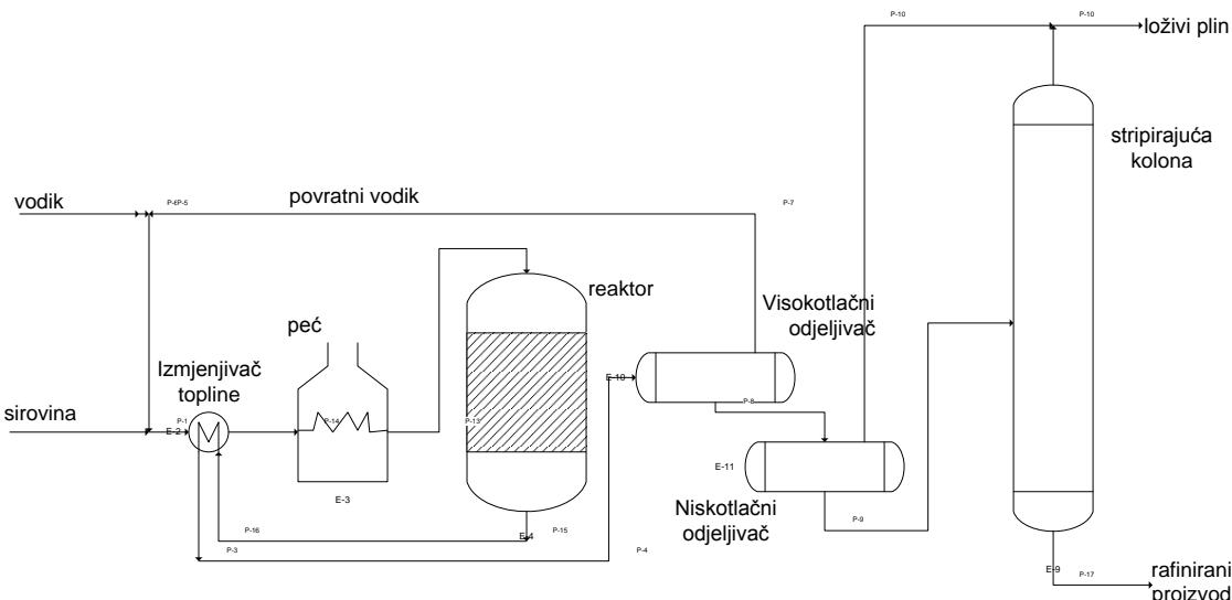
**Slika 1.** Shematski prikaz procesa hidrodesulfurizacije<sup>3</sup>
