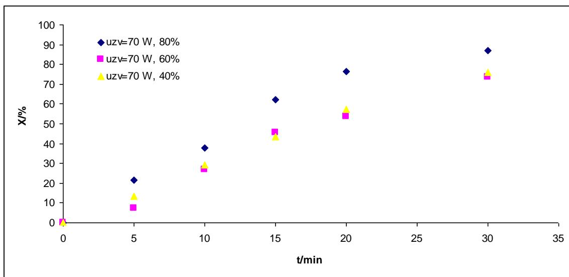
Slika 13. Utjecaj amplitude ultrazvuka i vremena reakcije na konverziju DBT-a u procesu oksidacije ( $T=70\text{ }^{\circ}\text{C}$ ,  $\text{O:K}=1:1.5$ )
