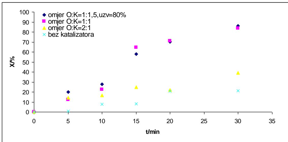
Slika 12. Utjecaj omjera oksidansa i katalizatora i vremena reakcije na konverziju DBT-a u procesu oksidacije ( $T=70^{\circ}\text{C}$ , užv=70 W, 80 %)
