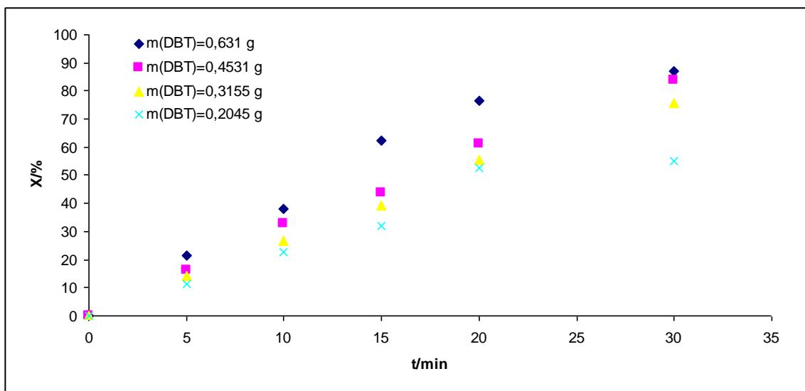
Slika 14. Utjecaj količine DBT-a u modelnoj otopini na konverziju u procesu oksidacije ( $T=70\text{ }^{\circ}\text{C}$ ,  $\text{uZV}= 70 \text{ W}$ ,  $80 \text{ \%}$ ,  $\text{O:K}=1:1,5$ )
