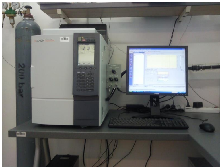
Slika 8. Plinski kromatograf Shimatzu GC
