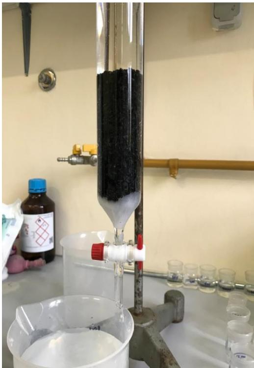
**Slika 3.2.** Dno kolone ispunjeno pamučnom vatom i granuliranim aktivnim ugljenom
