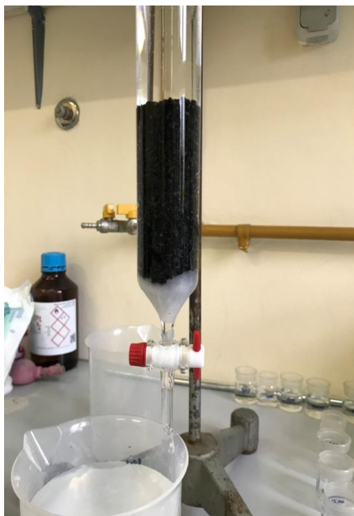
Slika 3.2. Dno kolone ispunjeno pamučnom vatom i granuliranim aktivnim ugljenom
