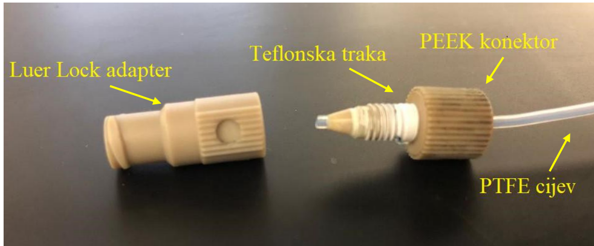
Slika 3.18. PTFE cijev provučena kroz PEEK konektor oko kojega je namotana teflonska traka radi boljeg brtvljenja, konektor se spaja na Luer Lock adapter koji se spaja na špricu
