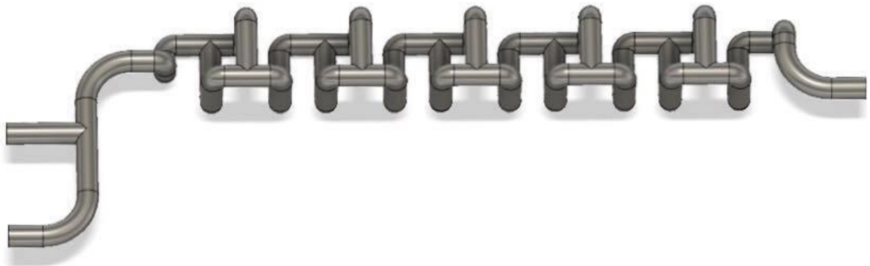
Slika 3.12. Cjevovod milireaktora Mobius 5
