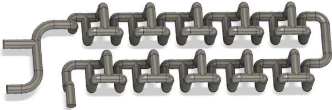
Slika 3.10. Cjevovod reaktora Mobius 10
