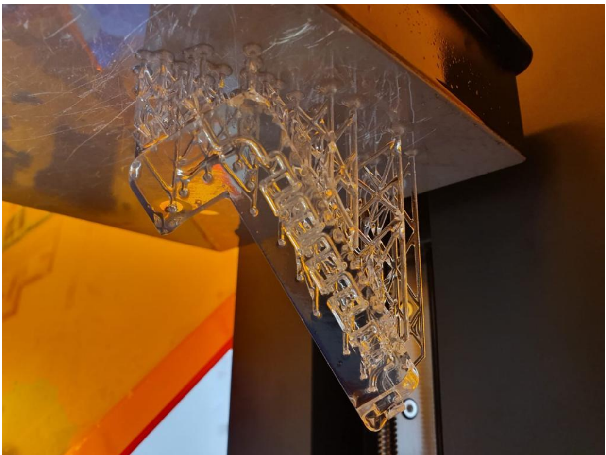
Slika 2.5. Milireaktor izrađen postupkom stereolitografije
