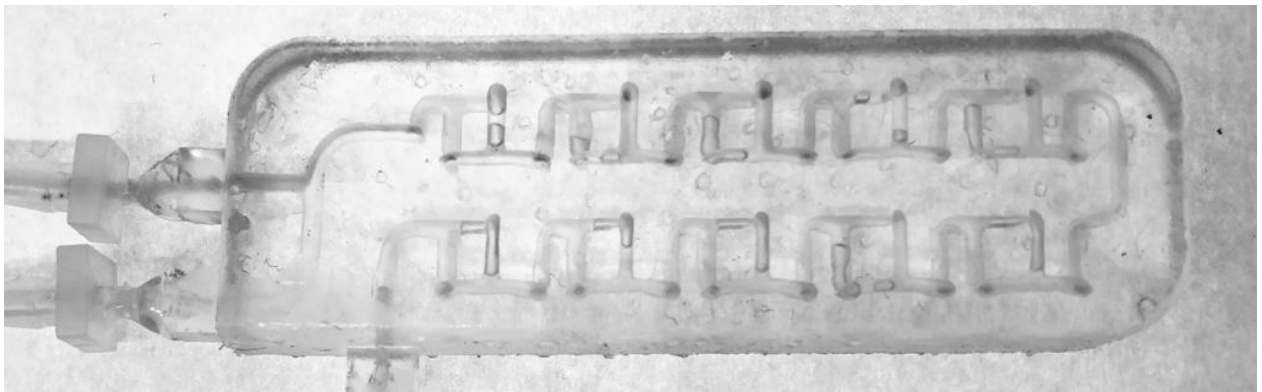
Slika 4.5. Mobius 10 milireaktor pri protoku od 34 \mu\text{L}/\text{min}
