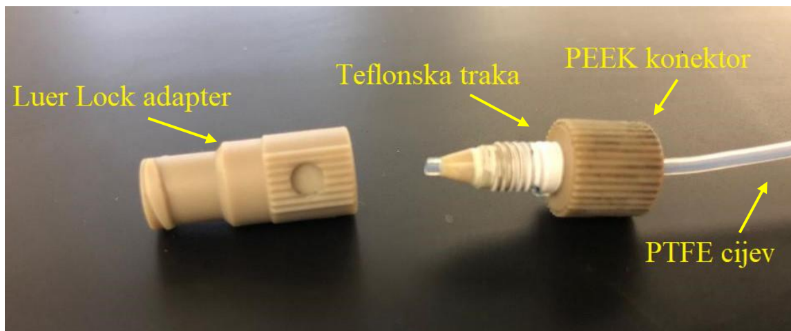
Slika 3.18. PTFE cijev provučena kroz PEEK konektor oko kojega je namotana teflonska traka radi boljeg brtvljenja, konektor se spaja na Luer Lock adapter koji se spaja na špricu
