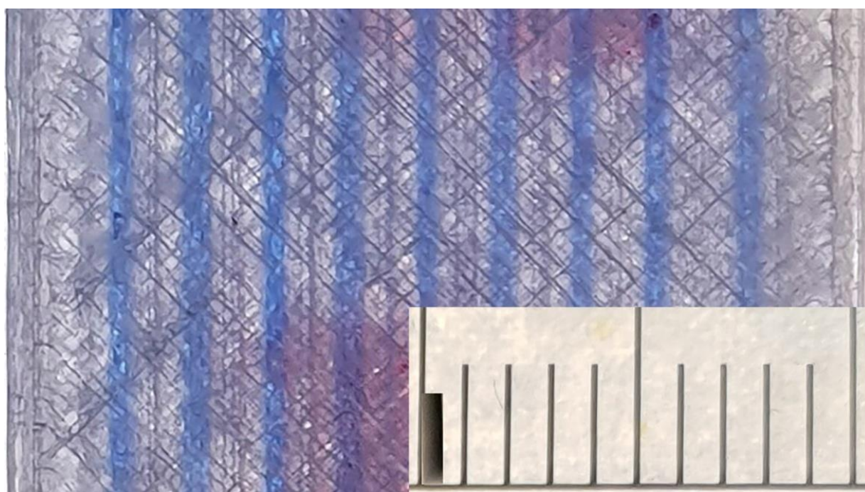
Slika 31. Određivanje širine kanala 3D-ispisanog mikoreaktora promjera 1,0 mm, pri ispisu extruder flow ratio je iznosio +50 % (skala iznosi 10 mm ili 349 piksela).
