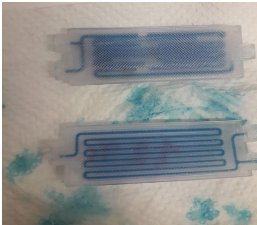
Slika 18. Mikroreaktor izrađen od materijala F43 Tough promjera kanala 1,5 mm (gore) i promjera kanala 1,2 mm (dolje)
