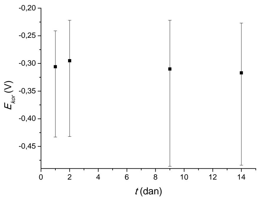
**Slika 12:** Prikaz ovisnosti korozijskog potencijala o vremenu za netretirane Cu/Ni uzorke
