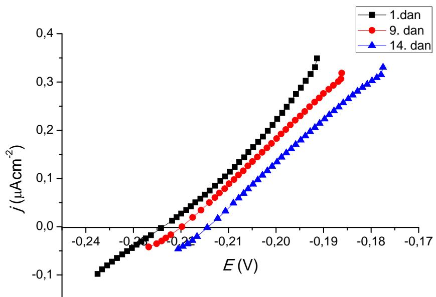
Slika 16: Polarizacijske krivulje za Cu/Ni elektrodu tretiranu 0,01M stearinskom kiselinom, u 1., 9. te 14. danu
