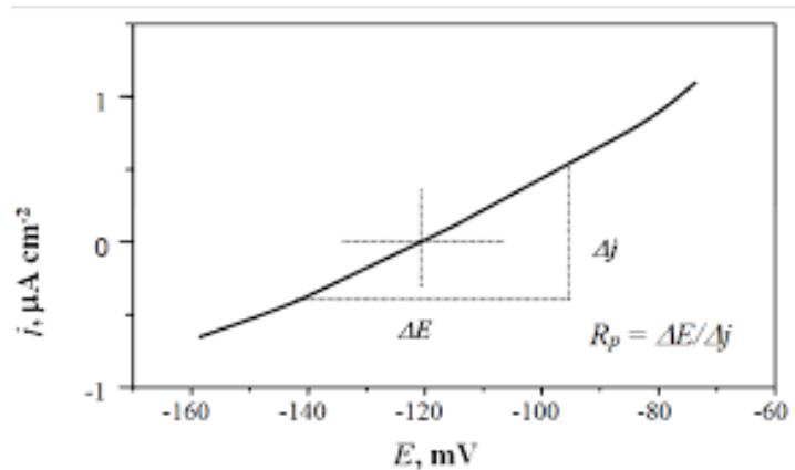
Slika 8: Određivanje polarizacijskog otpora prema *F.Mansfeldu*<sup>6</sup>
