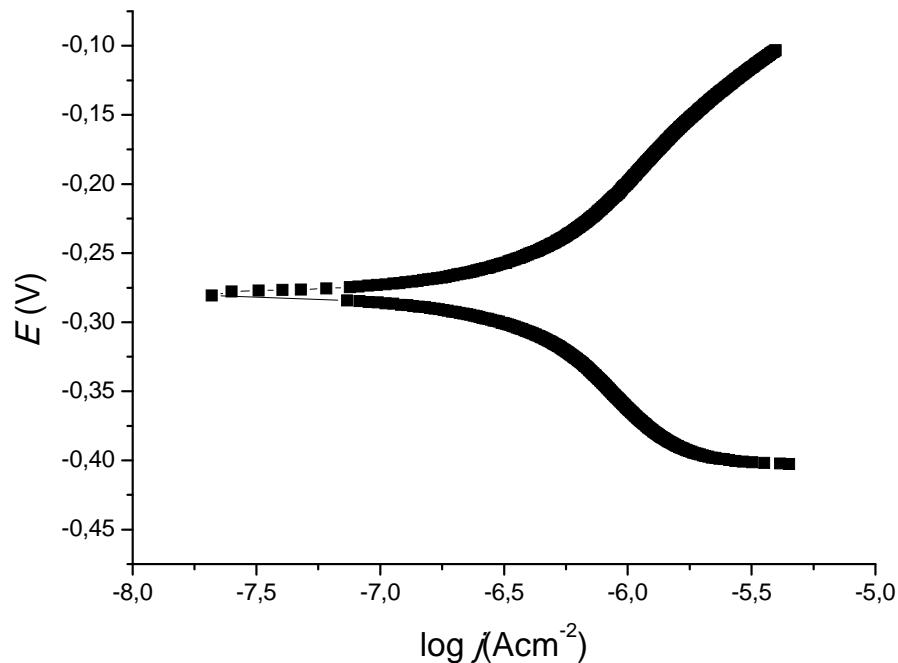
**Slika 15:Polarizacijska krivulja za netretirani Cu/Ni uzorak**
