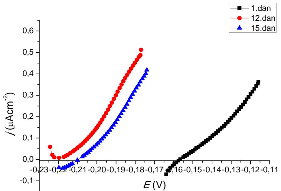
Slika 21: Polarizacijska krivulja za Cu/Ni elektrodu tretiranu 0,01M ODPA u 1., 13. te
