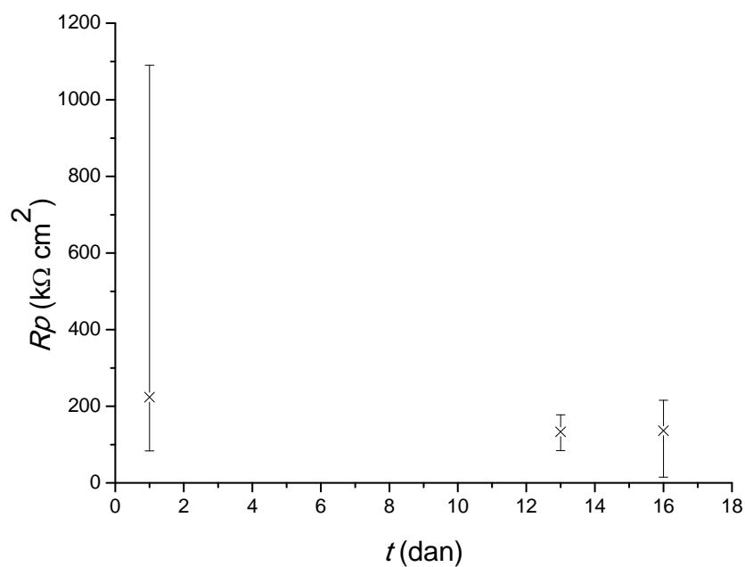
**Slika 23: Prikaz ovisnosti koroziskog otpora o vremenu za Cu/Ni uzorke tretirane 0,01
