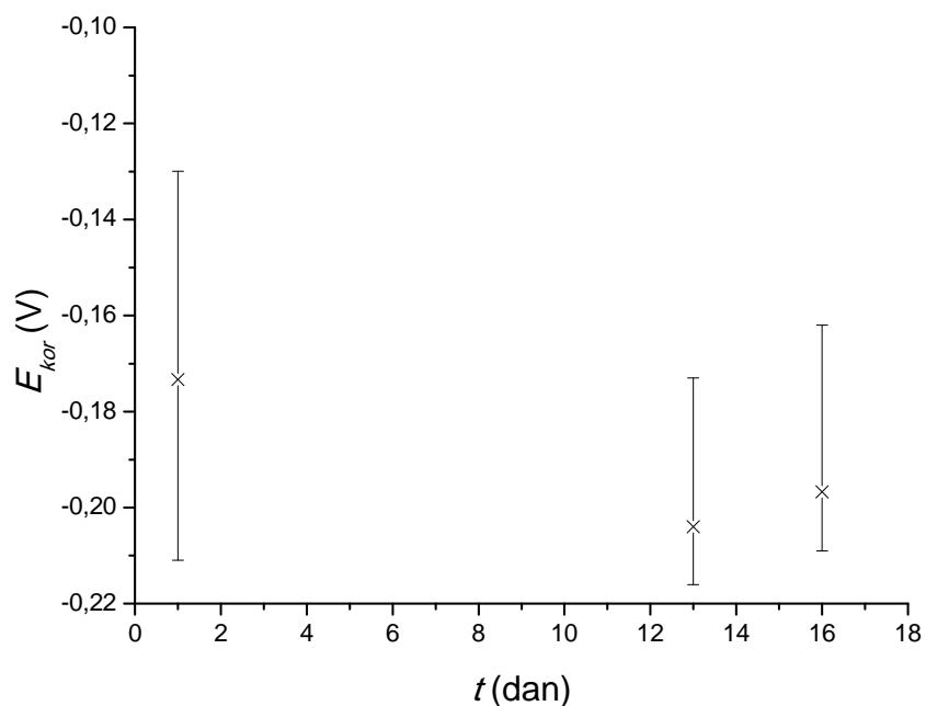
**Slika 22: Prikaz ovisnosti koroziskog potencijala o vremenu za Cu/Ni uzorke tretirane
