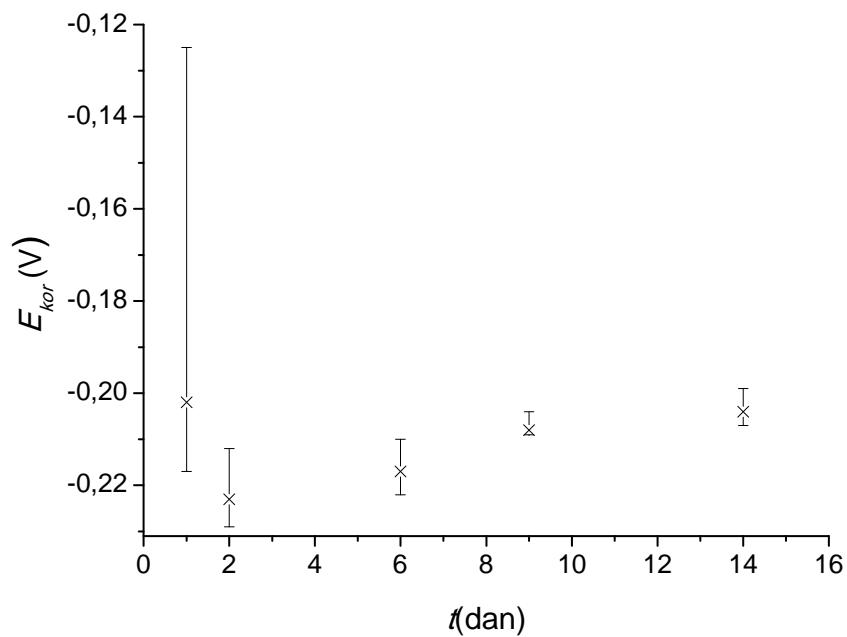
**Slika 17:** Prikaz ovisnosti koroziskog potencijala o vremenu za Cu/Ni uzorke tretirane 0,01 M stearinskom kiselinom
