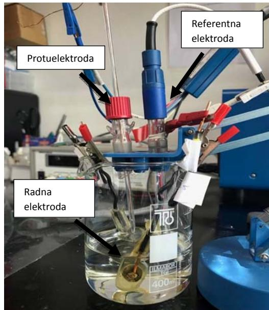
**Slika 7: Prikaz troelektrodne elektrokemijske čelije**
