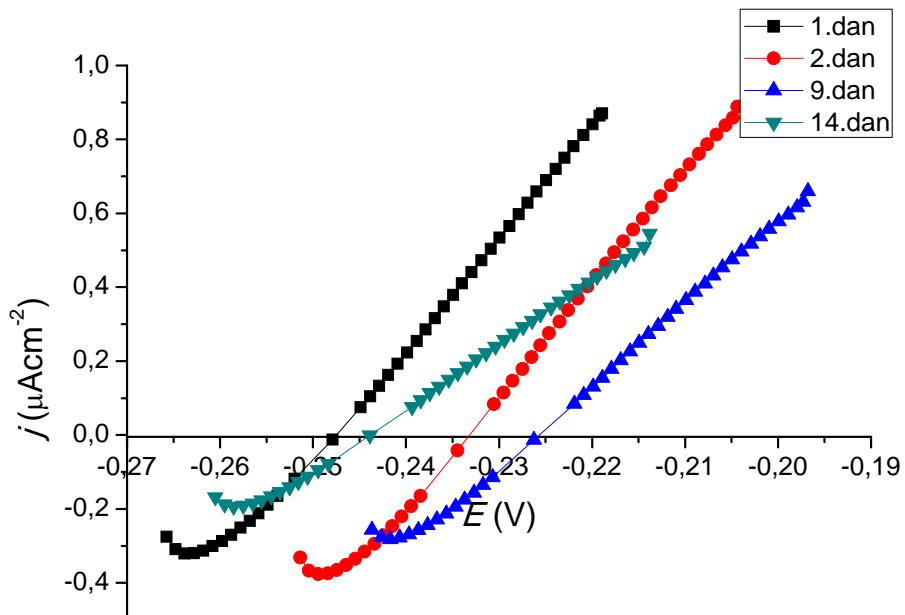
Slika 11:: Polarizacijska krivulja za netretiranu Cu/Ni elektrodu, u 1., 9. te 14. danu
