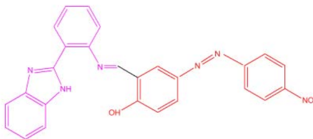
Slika 148. Struktura sintetiziranog organskog liganda nanesenog na nanočestice ZnO, ref. [15]
