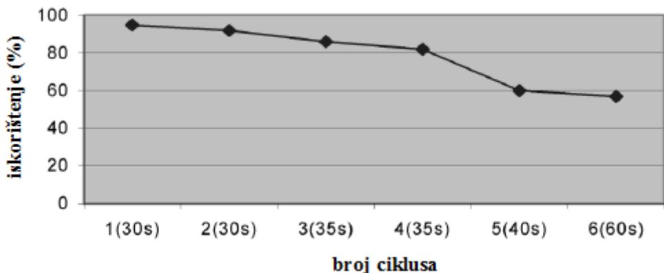
Slika 4. Iskorištenja dobivenog acetofenona nakon višestruke uporabe cinka u prahu kao katalizatora. U zagradi su navedena vremena odvijanja reakcije pod mikrovalnim zračenjem.
