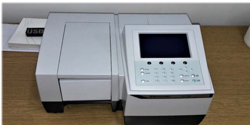
Slika 3.9. Fotografija spektrofotometra UV-1280 (Shimadzu, Kyoto, Japan)
