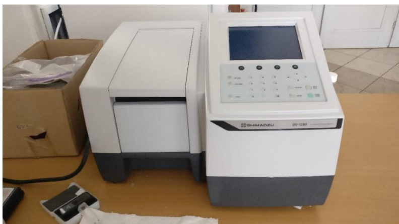
Slika 16. UV/Vis spektrofotometru Shimadzu UV-1280
