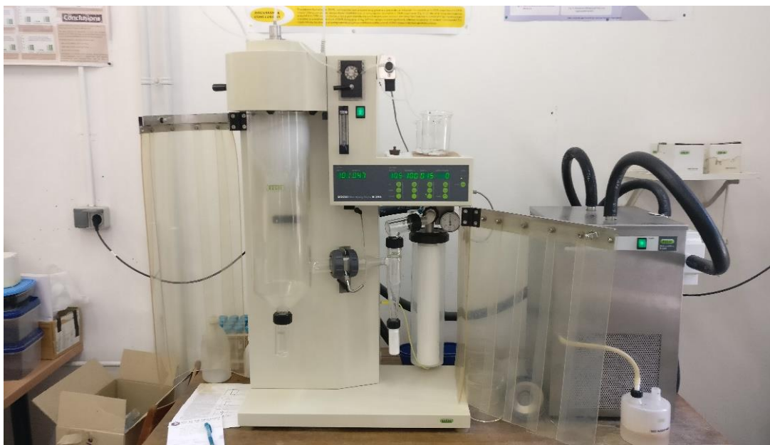
Slika 14. Sušionik s raspršivanjem B-290, BüchiLabortechnik AG
