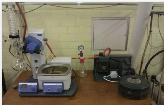
Slika 4. Rotacijski vakuum isparivač IKA RV 10, Basic.
