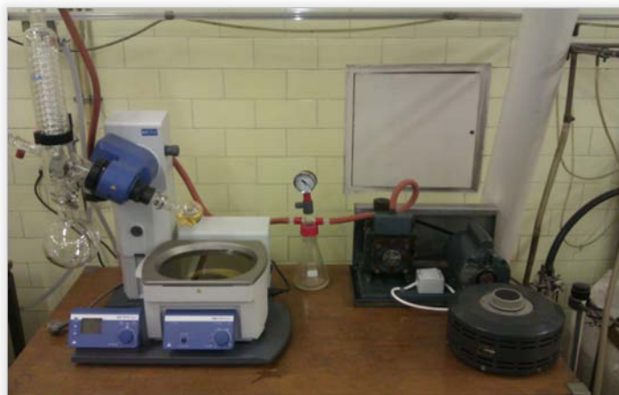
Slika 4. Rotacijski vakuum isparivač IKA RV 10, Basic.
