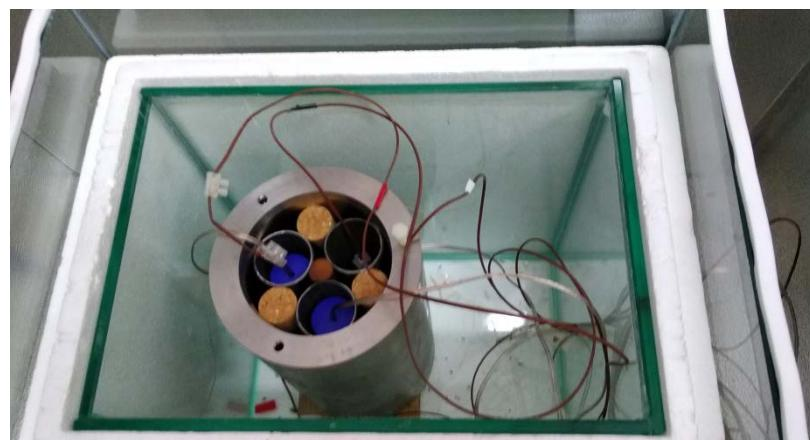
**Slika 5-2. Konstrukcija kalorimetra**
