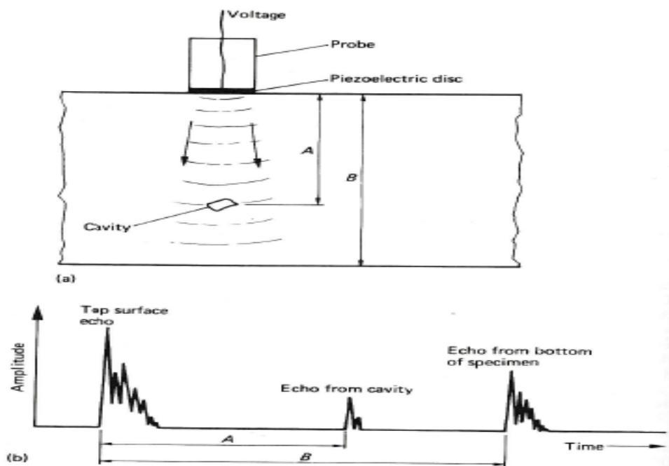
**Slika 4-2.** Prikaz osnovnog principa ultrazvučnog mjerjenja [25]
