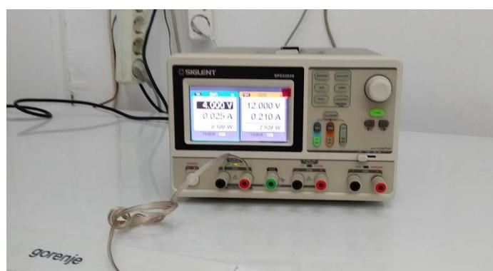
**Slika 5-4. Izvor istosmjerne struje**
