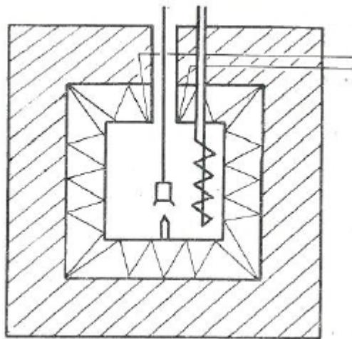
**Slika 3-2.** Shema konduksijskog kalorimetra [18]
