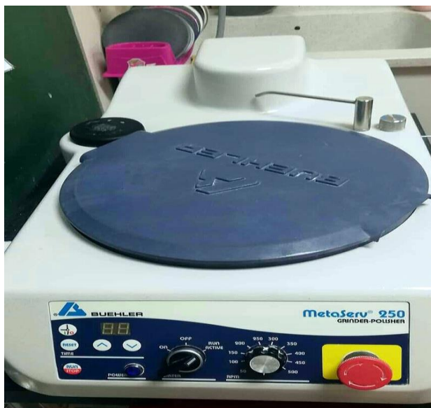
Slika 5. Uređaj za poliranje Buehler MetaServ 250
