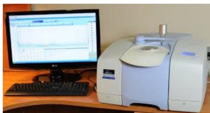
**Slika 3.4.1.** Perkin-Elmer Spectrum One FTIR spektrometar
