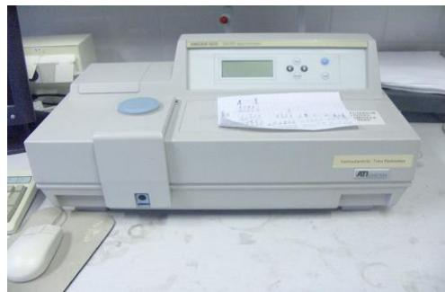
Slika 3.4.3. UV/Vis spektrofotometar
