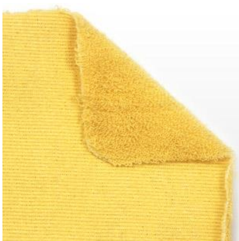
Slika 2. Kevlar, žuta boja uzrokovana je konjugacijom amidne veze i oksidacijskim skupinama na krajevima amina
