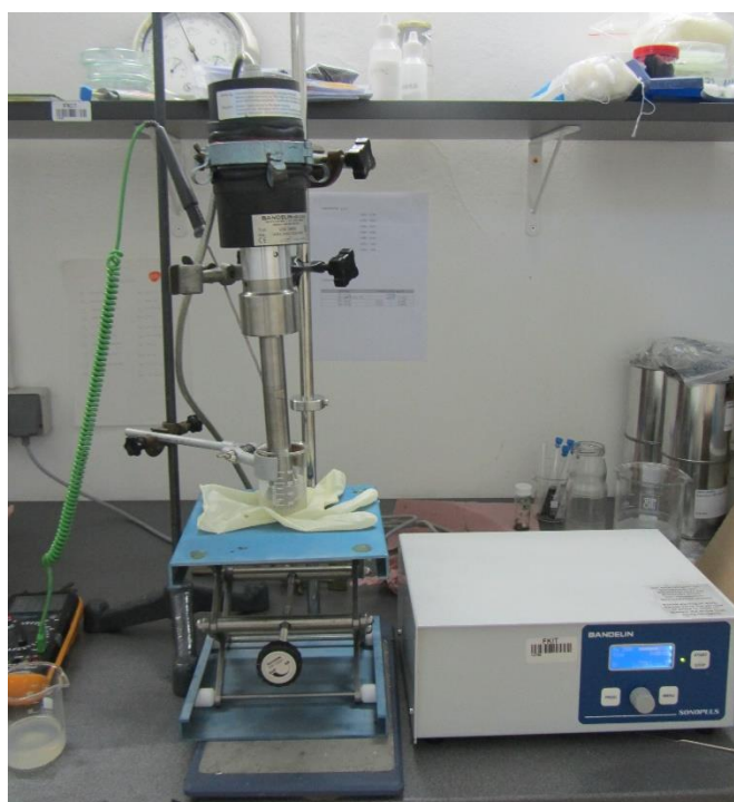
Slika 7. Bandelin Sonoplus, ultrazvučna sonda
