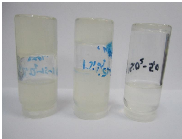
Slika 24. Preokrenute bočice uzoraka nanofluida sa udjelom SiO 2 0,5 % 10 % i 20 %
