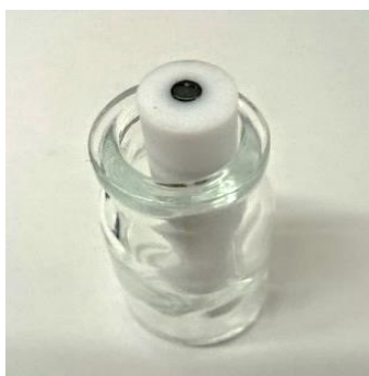
Slika 3.3. Elektroda od staklastog ugljika.
