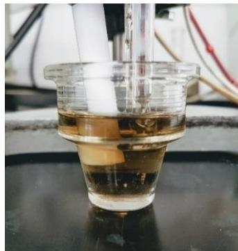
Slika 3.4. Elektrokemijska čelija za sintezu vodljivih polimera s troelektrodnim sustavom.
