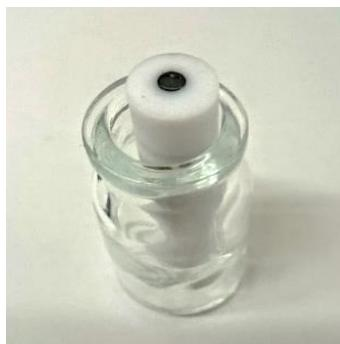
Slika 3.3. Elektroda od staklastog ugljika.
