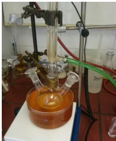
Slika 34. Prikaz šaržne sinteze FAME u tikvici s povratnim hladilom.
