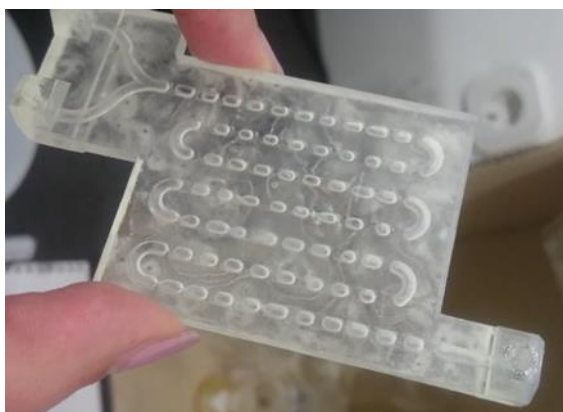
Slika 48. Fotografija milireaktora s oscilirajućim tokom fluida RSP-370-SLA.
