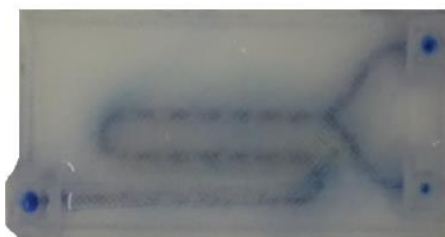
Slika 41. Reaktorski sustav izrađen od PMMA na pisaču Zortrax M200 uz vidljivu poroznost kanala.
