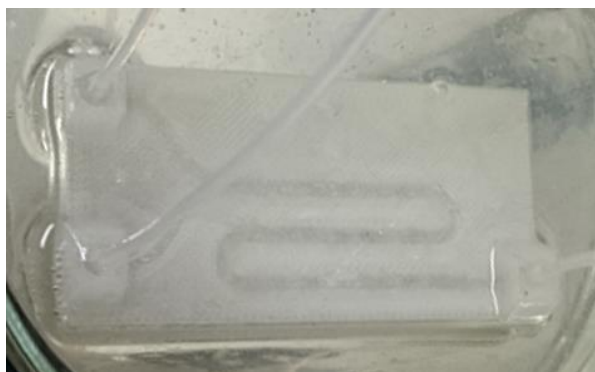
Slika 95. Fotografija RSP-120-FFF u uljnoj kupelji tijekom sinteze T = 60\text{ }^{\circ}\text{C} i \tau = 4,6\text{ min} .
