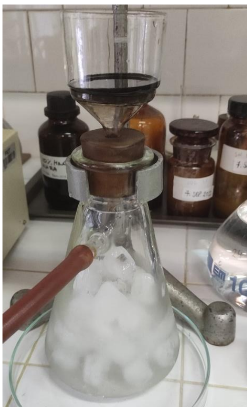
Slika 12. Filtriranje suspenzije interkaliranog grafita pomoću sinter lijevka
