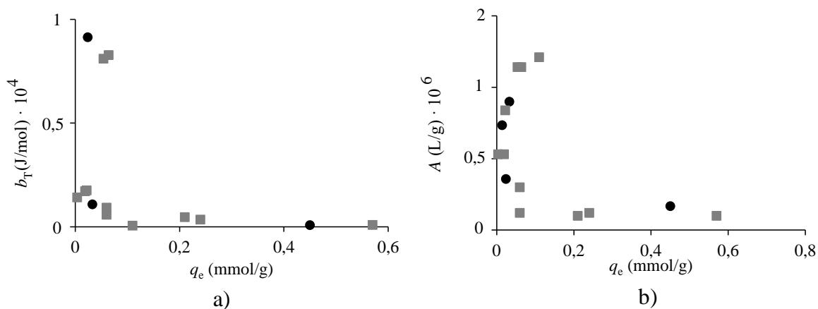
Slika 53 Odnos Tjomkinovih parametara  $b_T$  (a) i  $A$  (b) naspram eksperimentalno određenih adsorpcijskih kapaciteta ( $q_e$ ) za polifenole iz frakcija mesa (●) i kožice (■) jabuke. Početni volumen adsorbirajućih tvari iz frakcija iznosio je 300  $\mu$ L
