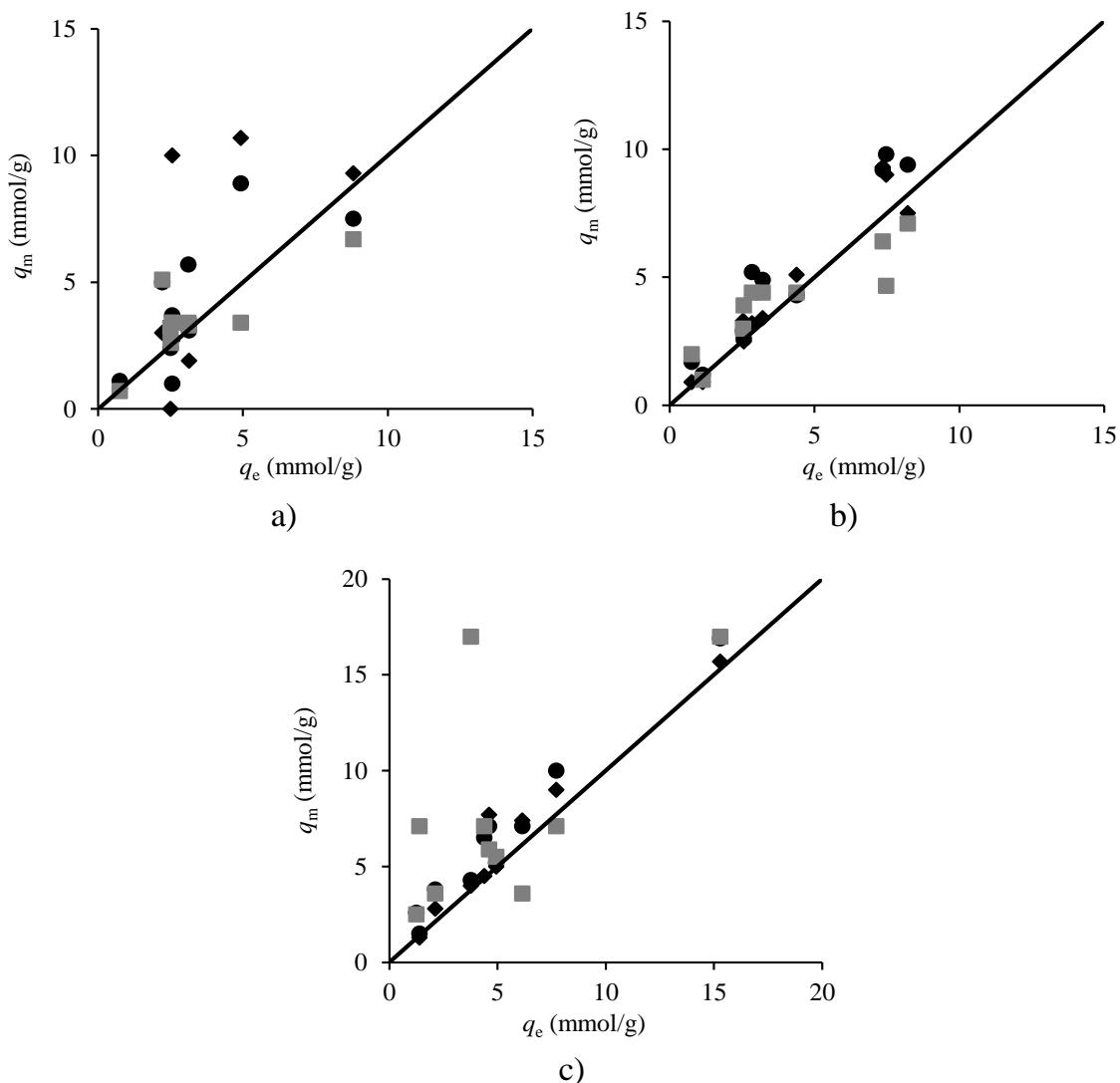
Slika 45 Odnos adsorpcijskih parametara  $q_m$  iz Langmuirove (●), Dubinjin-Raduškjevićeve (◆) i Hillove izoterme (■) naspram eksperimentalno određenih adsorpcijskih kapaciteta polifenola  $q_e$ . Prikazani rezultati odnose se za početne koncentracije od 150 mg/L, pri : a) pH 1,5; b) pH 5,5; c) pH 10,0
