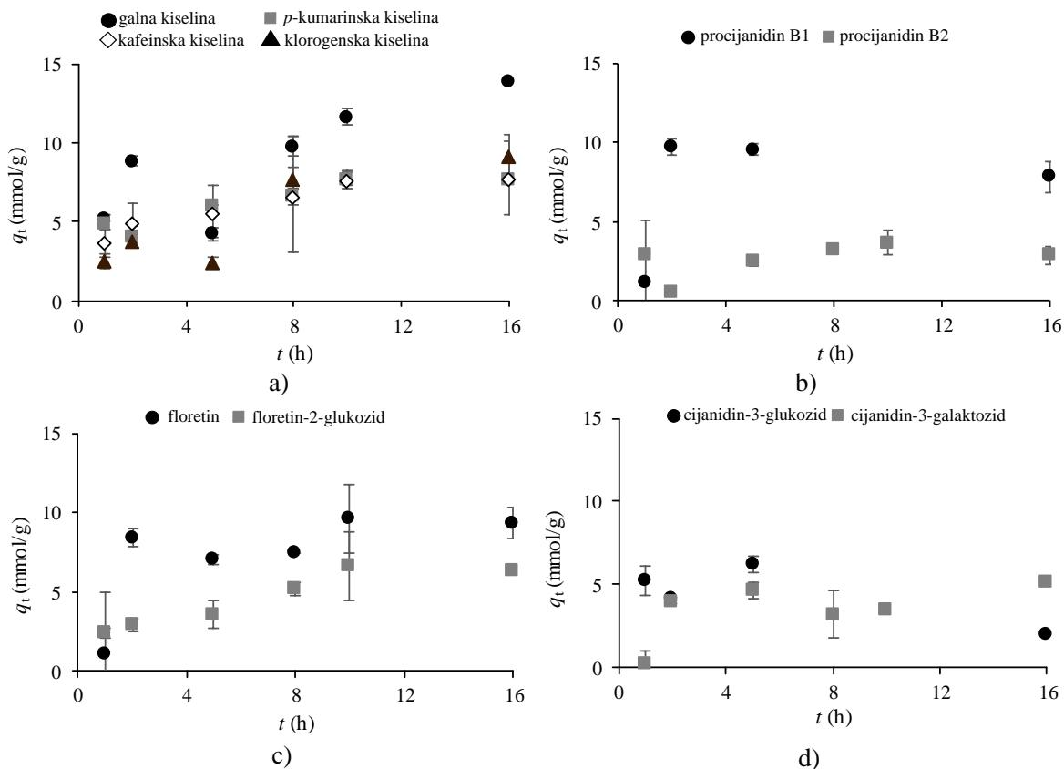
Slika 23 Ovisnost količine adsorbiranih polifenola na  $\beta$ -glukanu ( $q_t$ ) o vremenu adsorpcije ( $t$ ) za fenolne kiseline (a), flavan-3-ole (b), dihidrokalkone (c) i antocijanine (d) (adsorpcija pri 25 °C i pH medija 5,5)
