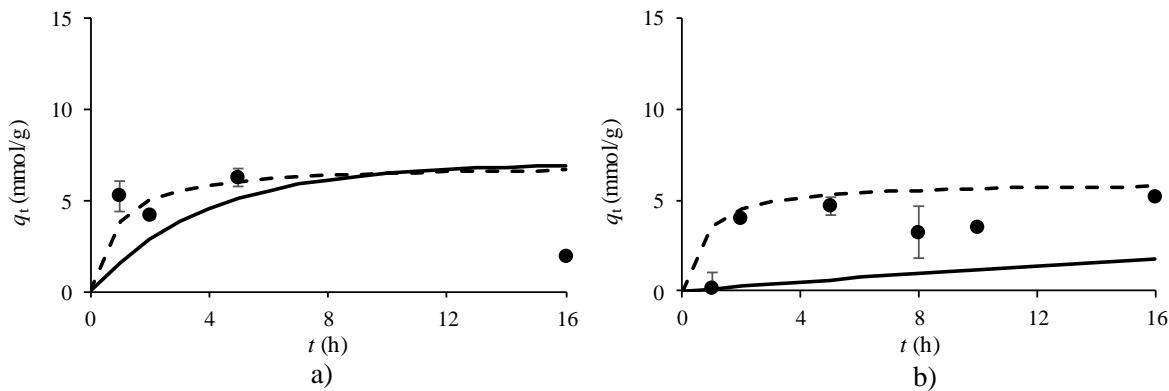
Slika 32 Slaganje kinetičkih modela pseudo-prvog reda (—) i pseudo drugog reda (---) reda s eksperimentalnim podacima  $q_e$  (●) za adsorpciju cijanidin-3-glukozida (a) i cijanidin-3-galaktozida (b) na  $\beta$ -glukanu
