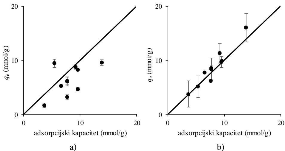
Slika 28 Odnos adsorpcijskih kapaciteta  $q_e$  iz pseudo-prvog (a) i pseudo drugog reda (b) naspram eksperimentalno određenih adsorpcijskih kapaciteta polifenola. Prikazani eksperimentalni rezultati odnose se za početne koncentracije od 150 mg/L, pH-vrijednost medija 5,5 te temperatu 25 °C
