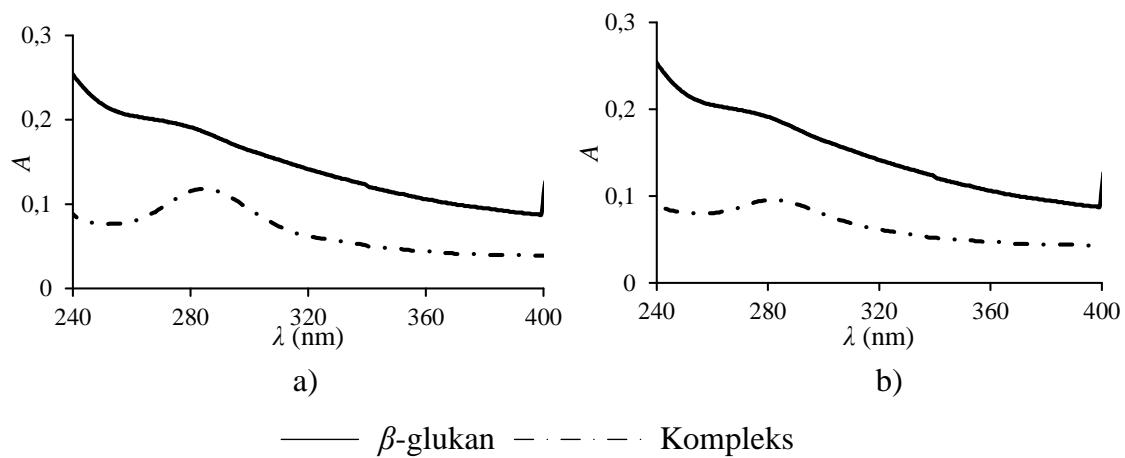
Slika 39 UV/Vis-spektri  $\beta$ -glukana i kompleksa (dihidrokalkon –  $\beta$ -glukan) za adsorpciju na 25 °C (pH 5,5): a) floretin; b) floretin-2-glukozid
