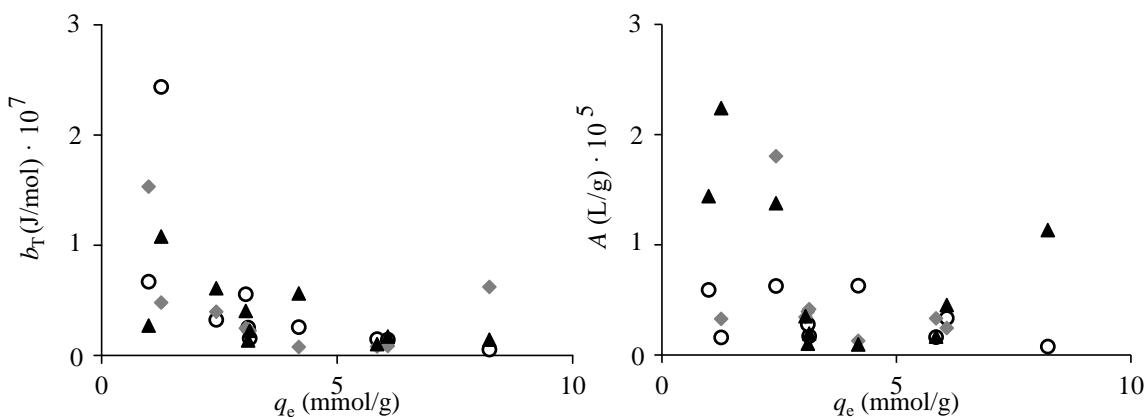
Slika 21 Odnos Tjomkinovog parametara  $b_T$  (a) i  $A$  (b) naspram eksperimentalno određenih adsorpcijskih kapaciteta (s početnom koncentracijom 150 mg/L) na 25 ( $\circ$ ), 37 ( $\diamond$ ) i 45 °C ( $\blacktriangle$ )
