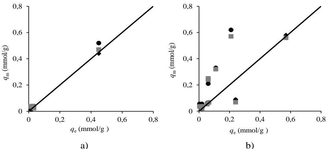
Slika 52 Odnos adsorpcijskih parametara  $q_m$  iz Langmuirove (●), Dubinin-Raduškjevičeve (◆) i Hillove izoterme (■) naspram eksperimentalno određenih adsorpcijskih kapaciteta polifenola  $q_e$ . Prikazani rezultati odnose se za početne koncentracije od 300  $\mu$ L ekstrakta, za frakciju mesa (a) i kožice (b) jabuke
