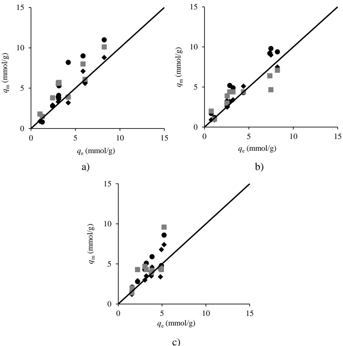
Slika 20 Odnos adsorpcijskih parametara  $q_m$  iz Langmuirove (●), Dubinjin-Raduškjevićeve (◆) i Hillove izoterme (■) naspram eksperimentalno određenih adsorpcijskih kapaciteta polifenola  $q_e$ . Prikazani rezultati odnose se za početne koncentracije od 150 mg/L, pH-vrijednost medija 5,5 te temperature: a) 25 °C, b) 37 °C i c) 45 °C.
