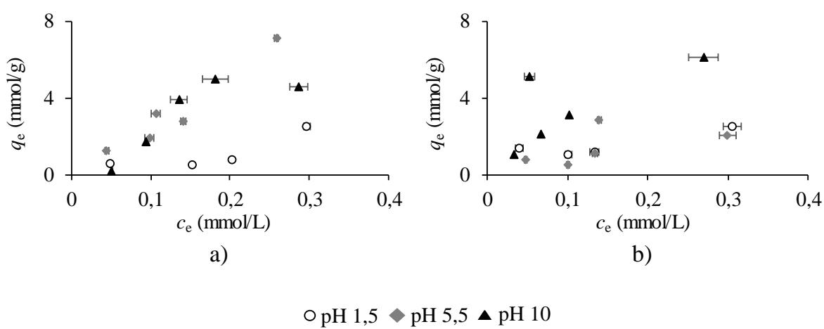
Slika 44 Adsorpcijska ravnoteža za adsorpciju cijanidin-3-glukozida (a) i cijanidin-3-galaktozida (b) na  $\beta$ -glukanu na pH 1,5, 5,5 i 10,0
