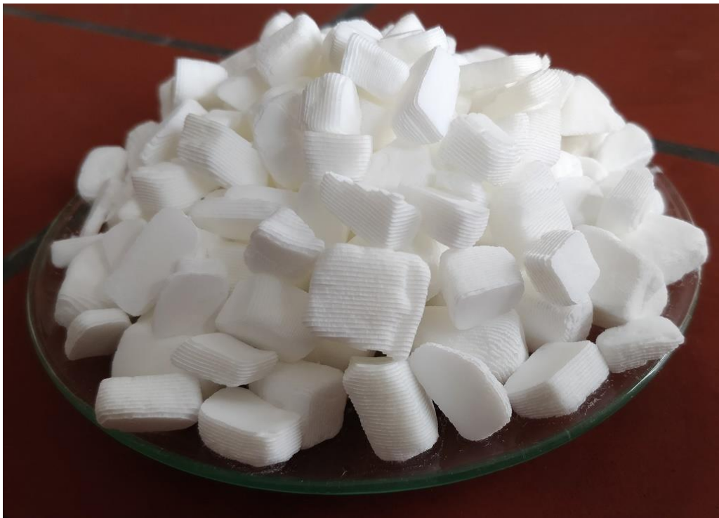
Slika 13. Kalcij-fosfatni nosači dobiveni hidrotermalnom sintezom sipine kosti.
