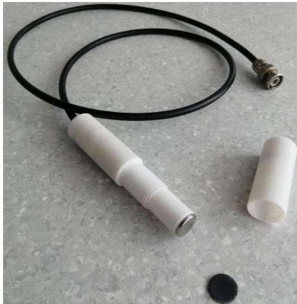
Slika 3.7 Prikaz višenamjenskog tijela elektrode i jedne pripremljene membrane
