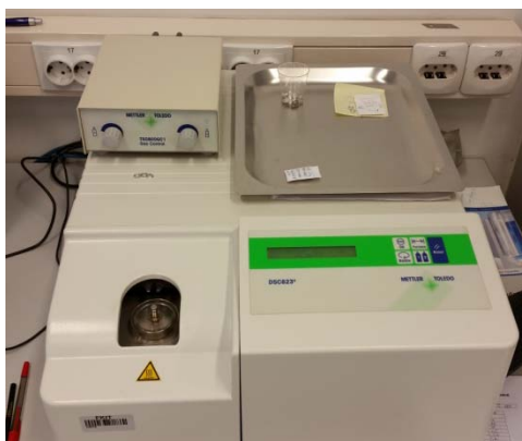
Slika 13. Diferencijalni pretražni kalorimetar, Mettler Toledo DSC 822e
