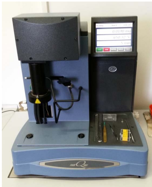
Slika 14. Uređaj za termogravimetrijsku analizu, TA Instruments Q500
