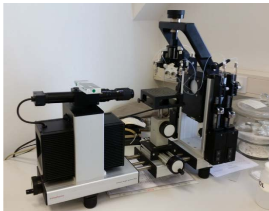
Slika 11. Goniometar, instrument za mjerenje kontaktnog kuta, DataPhysics OCA 20 Instrument
