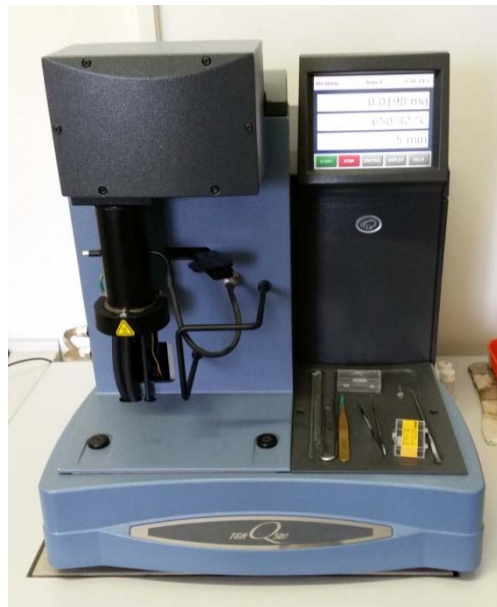
Slika 14. Uređaj za termogravimetrijsku analizu, TA Instruments Q500
