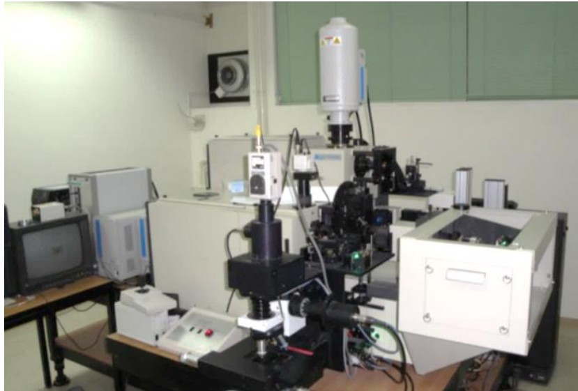
Slika 3.3. Uređaj za Ramanovu spektroskopiju u Laboratoriju za molekulska fiziku i sinteze novih materijala, Zavod za fiziku materijala, Institut Ruđer Bošković.
