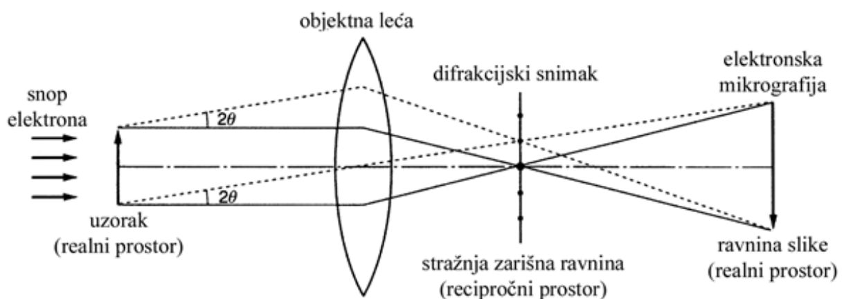
Slika 2.20. Princip nastajanja slike u TEM-u [91].
