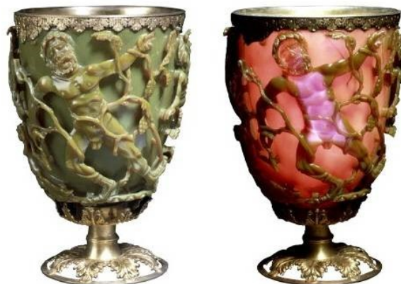
Slika 4. Likurgov kalež promatran u refleksiji ( lijevo ) i transmisiji svjetlosti ( desno ). (Slika preuzeta s https://www.sciencedirect.com/topics/engineering/lycurgus-cup , 10.02.2020)
