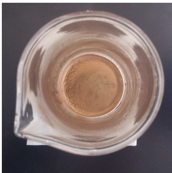
Slika 37. Suhi talog nanočestica srebra stabiliziranih poli(metakrilnom kiselinom).
