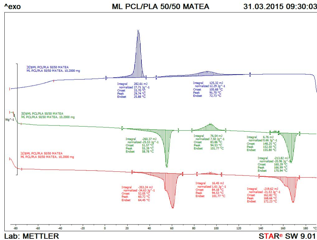
**Slika 30.** DSC termogrami netretirane PCL/PLA polimerne mješavine 1. i 2. ciklusa zagrijavanja i ciklusa hlađenja
