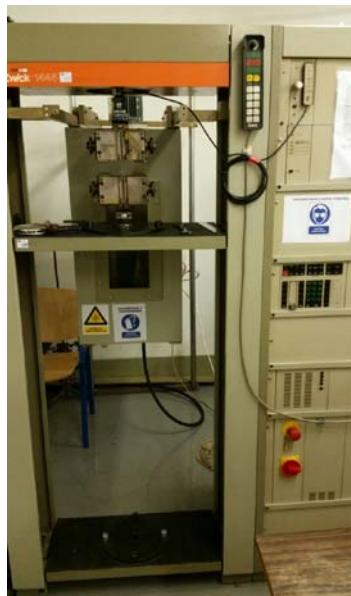
**Slika 17.**Univerzalni stroj za mehanička ispitivanja Zwick 1445, spojen s PC računalom
