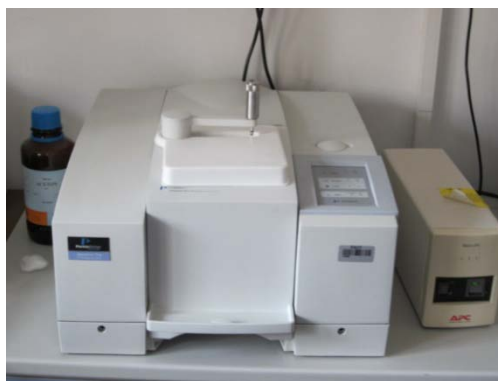
Slika 14. FTIR spektrometar, Perkin Elmer Spectrum One Spectrometer s ATR komorom
