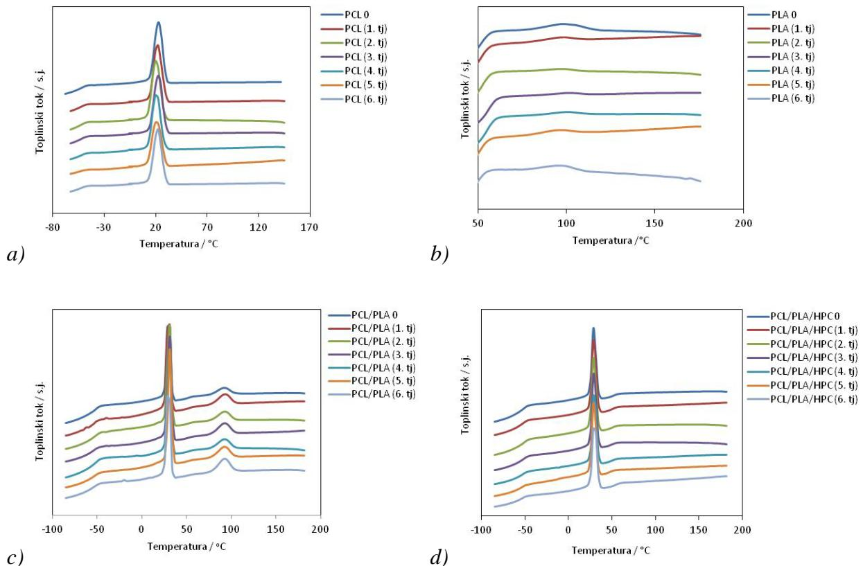
**Slika 32.** Usporedni DSC termogrami ciklusa hlađenja a) PCL, b) PLA polimera i c) PCL/PLA, d) PCL/PLA/HPC polimernih mješavina prije i nakon hidrolitičke razgradnje tijekom šest tjedana u HBSS otopini
