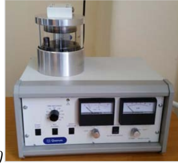
Slika 18. a) Pretražni elektronski mikroskop Tescan Vega serija 3, Bruker i b) uređaj za nparivanje vodljivog sloja zlata i napareni uzorci
