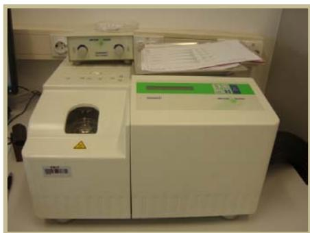
**Slika 15.** Diferencijalni pretražni kalorimetar, Mettler Toledo DSC 823e
