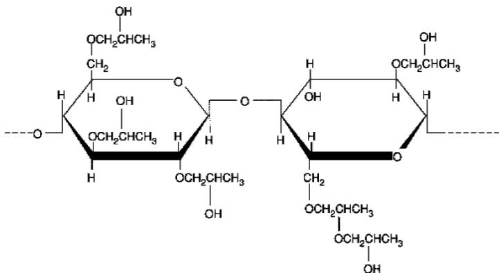
**Slika 7.** Struktura hidroksipropilceluloze<sup>22</sup>
