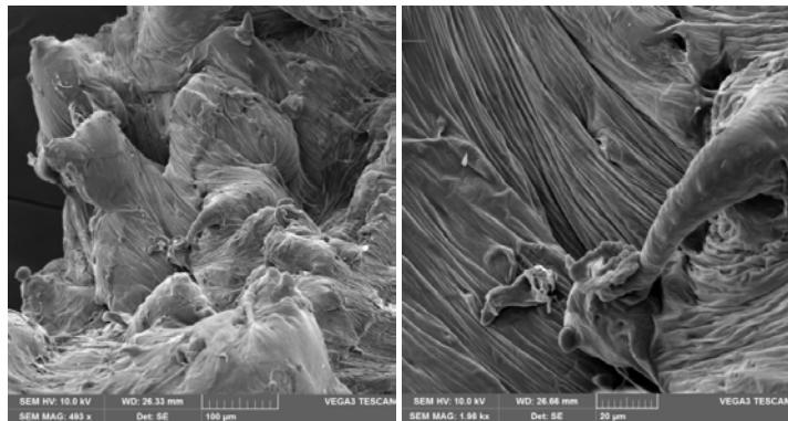
**Slika 45.** SEM mikrografija površine loma PCL polimera nakon 6. tjedna hidrolitičke razgradnje u HBSS otopini
