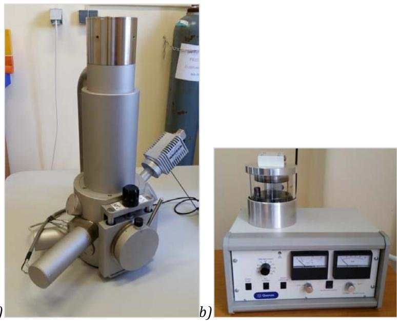
**Slika 18.** a) Pretražni elektronski mikroskop Tescan Vega serija 3, Bruker i
