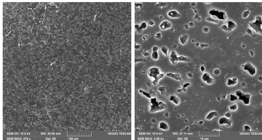
**Slika 56.** SEM mikrografija površine PCL/PLA/HPC polimerne mješavine nakon 6. tjedna hidrolitičke razgradnje u HBSS otopini, pri različitim povećanjima
