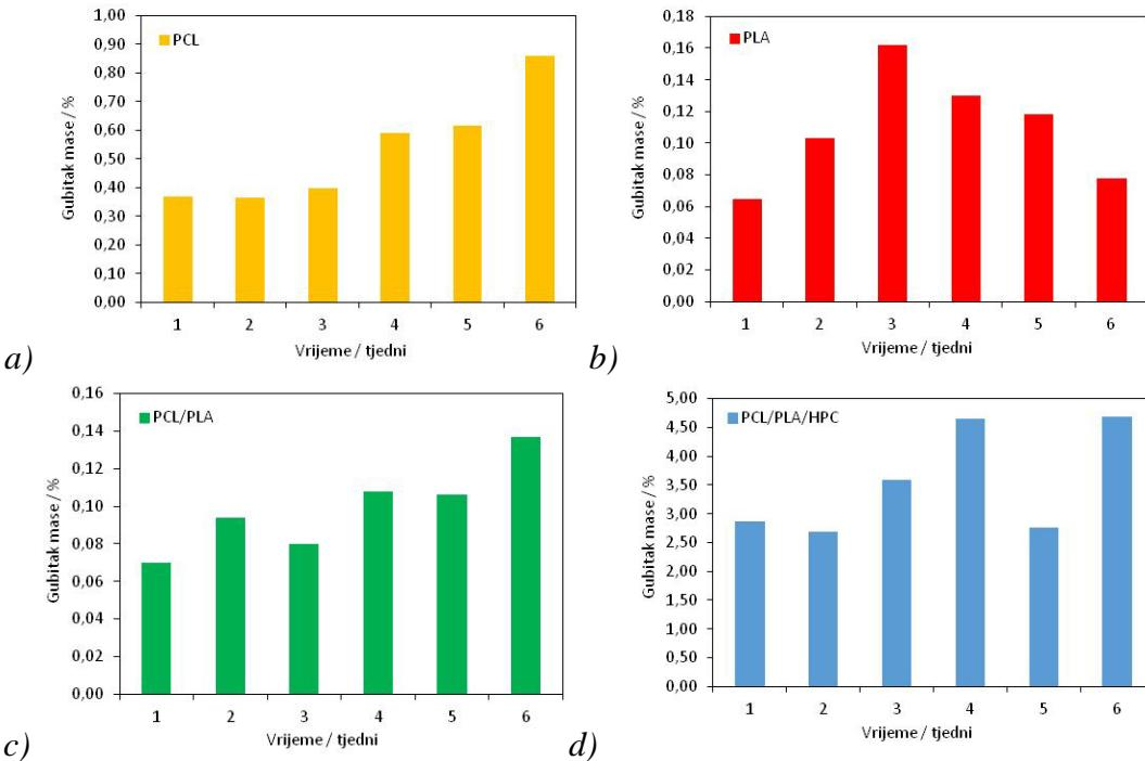
**Slika 20.** Gubitak mase a) PCL, b) PLA polimera i c) PCL/PLA, d) PCL/PLA/HPC mješavina tijekom 6. tjdana hidrolitičke razgradnje u HBSS otopini
