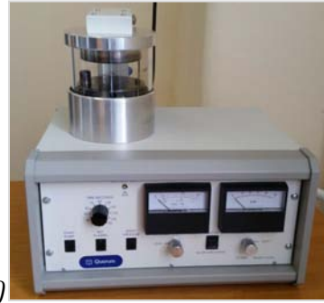
Slika 18. a) Pretražni elektronski mikroskop Tescan Vega serija 3, Bruker i b) uređaj za napanje vodljivog sloja zlata i napareni uzorci
