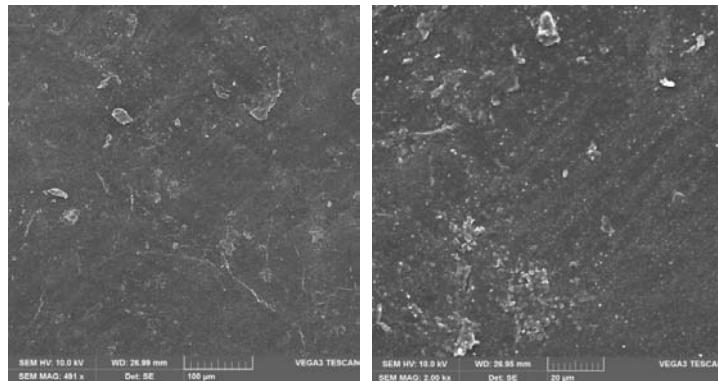
**Slika 47.** SEM mikrografija površine PLA polimera nakon 6. tjedna hidrolitičke razgradnje u HBSS otopini
