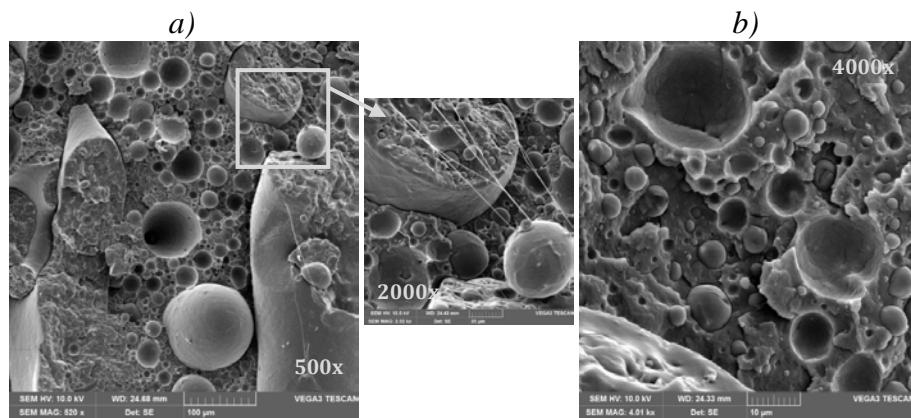
**Slika 54.** SEM mikrografija površine loma PCL/PLA polimera nakon 6. tjedna hidrolitičke razgradnje u HBSS otopini
