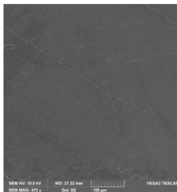
**Slika 46.** SEM mikrografije površine PLA polimera prije razgradnje
