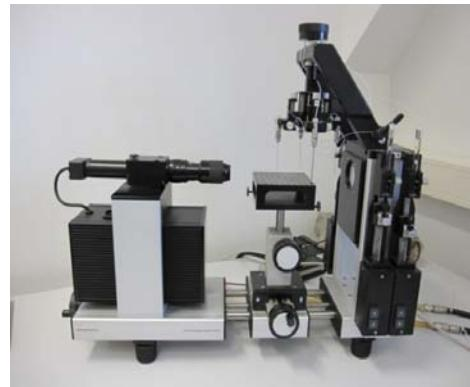
**Slika 13.** Goniometar, instrument za mjerjenje kontaktnog kuta, DataPhysics OCA 20
