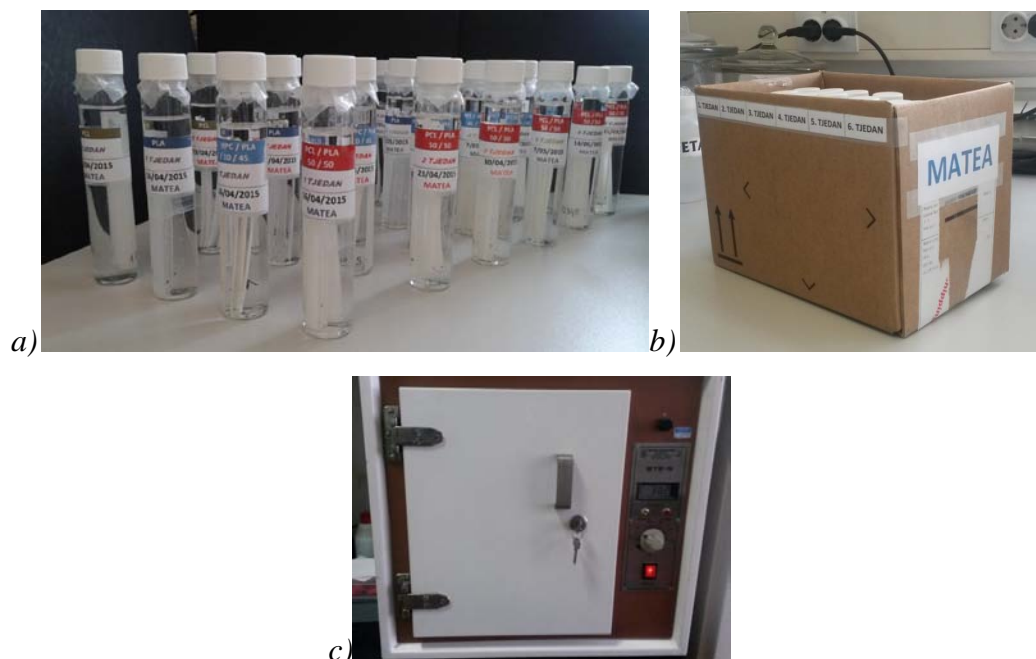
Slika 12. a) Posudice s uzorcima PCL, PLA, PCL/PLA i PCL/PLA/HPC mješavina prije stavljanja u inkubator, b) kutija s uzorcima i c) inkubator
