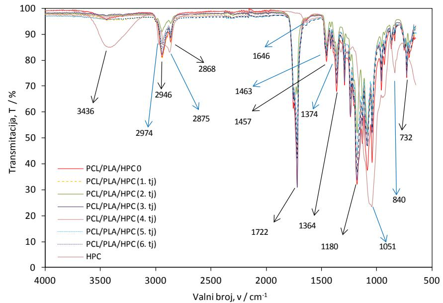
**Slika 27.** Usporedni FTIR spektri PCL/PLA/HPC mješavina prije i nakon hidrolitičke razgradnje tijekom šest tjedana u HBSS otopini
