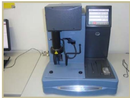
**Slika 16.** Termogravimetar, TA Instruments Q500
