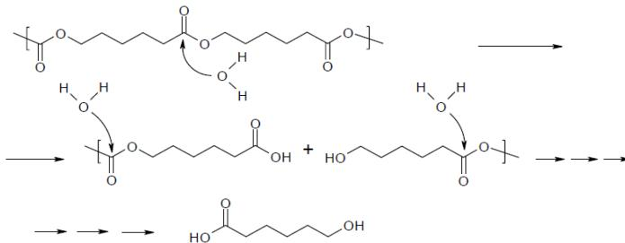
**Slika 8.** Shematski prikaz hidrolize PCL-a<sup>3</sup>
