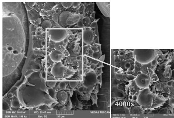
**Slika 53.** SEM mikrografija površine loma PCL/PLA polimerne mješavine prije razgradnje
