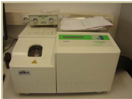
Slika 15. Diferencijalni pretražni kalorimetar, Mettler Toledo DSC 823e
