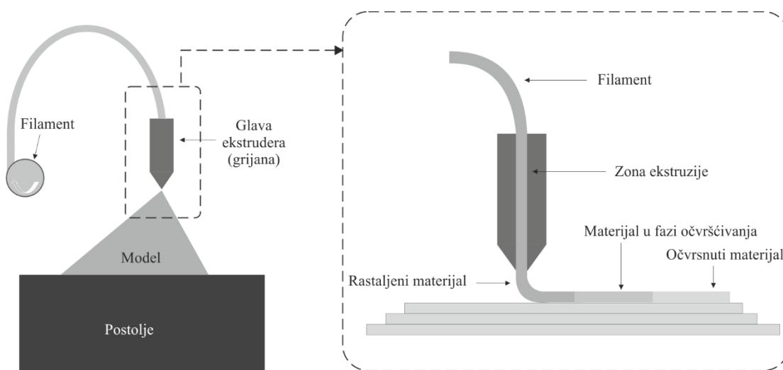
**Slika 4.** Princip izrade proizvodnjom rastaljenim filamentom (FFF)
