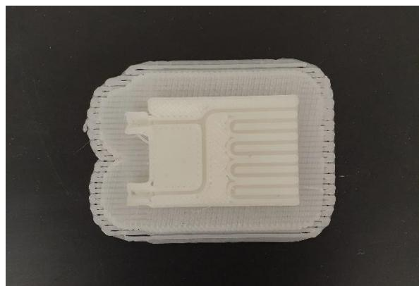
**Slika 74.** Dio mikroreaktora s vidljivim mikrokanalima
