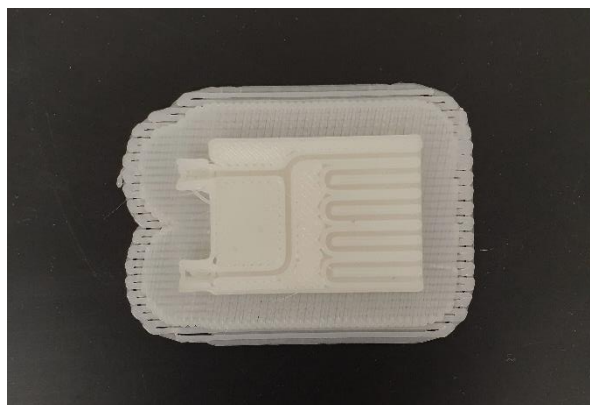
Slika 74. Dio mikroreaktora s vidljivim mikrokanalima
