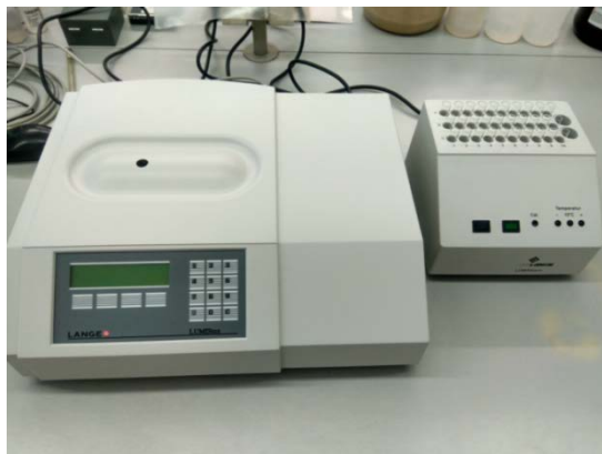
Slika 27. Luminometar i termostatirani blok, HACH LANGE, LUMISTox 300
