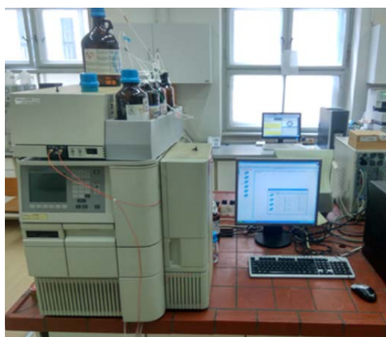
Slika 25. Waters 2795 Alliance HPLC sustav s 2996 PDA detektorom
