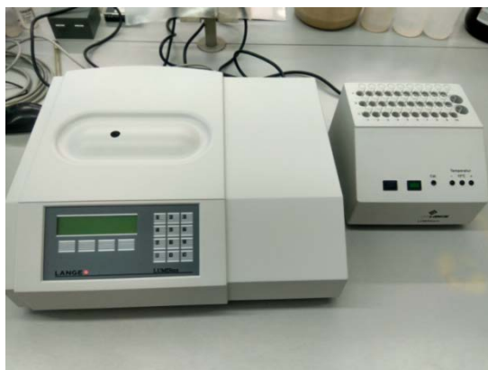
Slika 27. Luminometar i termostatirani blok, HACH LANGE, LUMISTox 300
