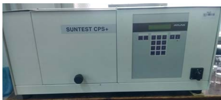
Slika 24. Uređaj za osvjetljavanje umjetnim Sunčevim zračenjem SunTest CPS+, Atlas (300 – 800 nm)
