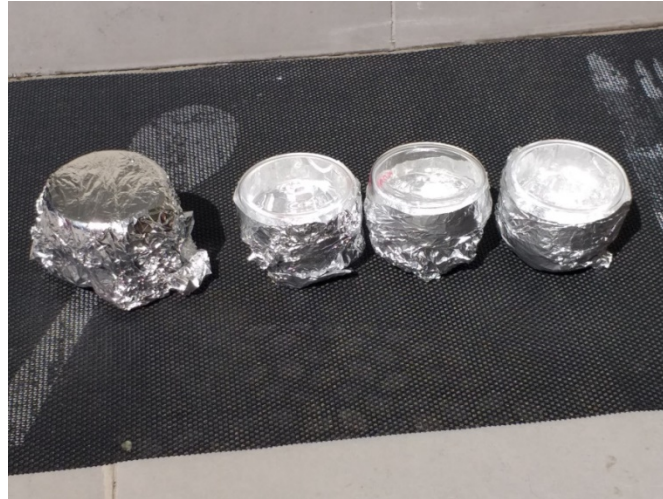
Slika 1.P Fotolitička razgradnja hidroksiklorokina za vrijeme sunčanog dana pod utjecajem prirodnog Sunčeva zračenja
