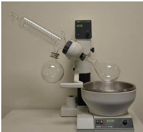
Slika 3.3. Rotacijski uparivač, R-114/A, Büchi
