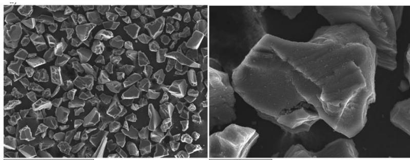
Slika 4.2 Fotografija ugljičnog kserogela dobivena elektronskim pretražnim mikroskopom.<sup>[41]</sup>
