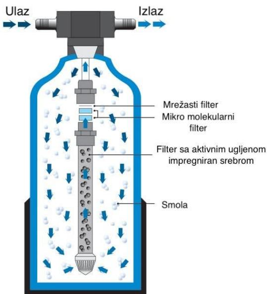
Slika 3.10 Prikaz procesa ionske izmjene sa smolom.<sup>[35]</sup>
