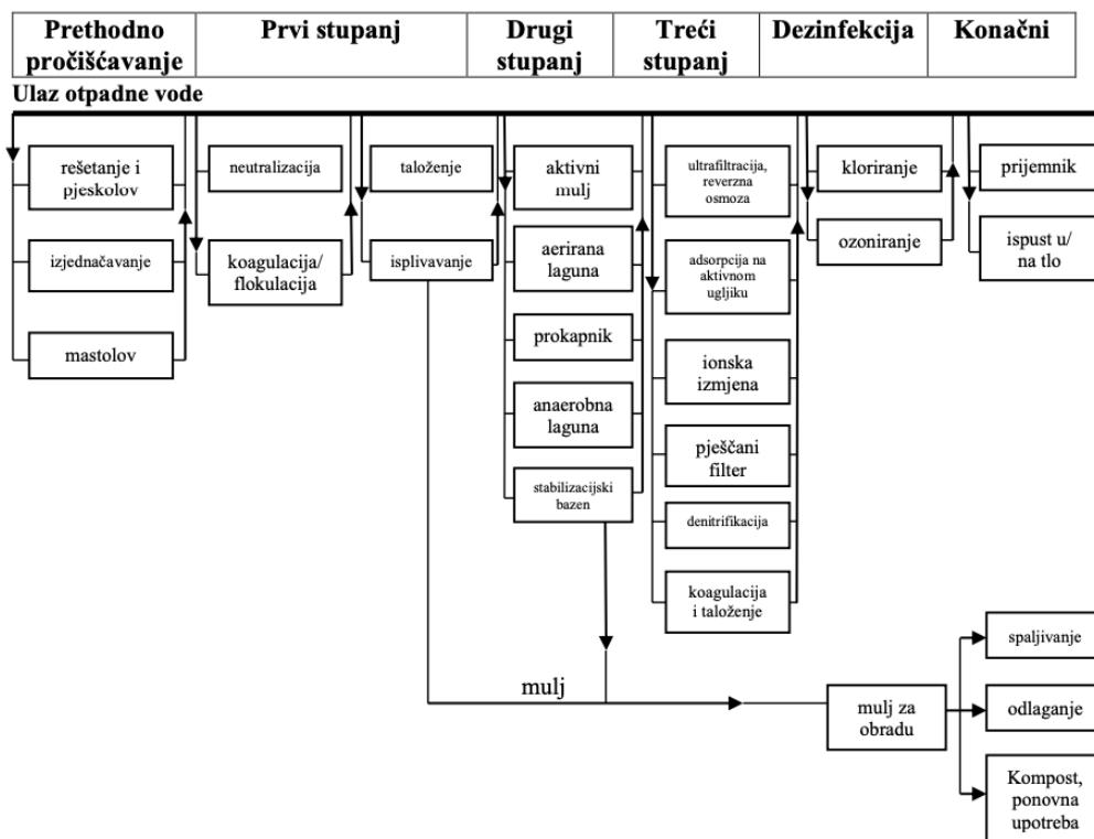
Slika 3.2 Prikaz cijelog tehnološkog procesa obrade otpadnih voda. [21]
