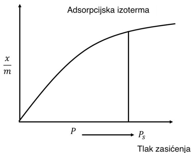
Slika 2.6 Grafički prikaz osnovne adsorpcijske izoterme.<sup>[12]</sup>
