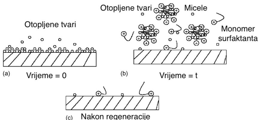
Slika 4.3 Shematski prikaz regeneracije aktivnog ugljena pomoću surfaktanta.<sup>[45]</sup>
