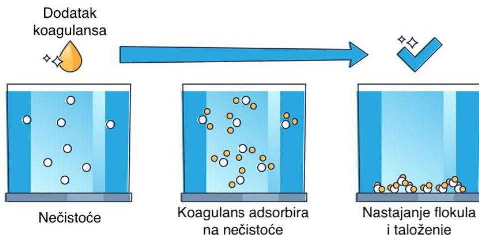
Slika 3.9 Prikaz procesa koagulacije/flokulacije.<sup>[33]</sup>
