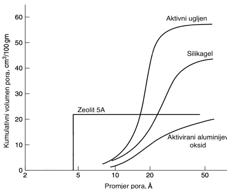
Slika 2.3 Grafički prikaz raspodjele veličina pora za aktivni ugljen, silikagel, aktivirani aluminijev oksid i zeolit 5A.<sup>[4]</sup>
