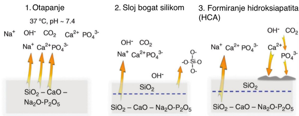
Slika 2.3 Prikaz interakcije bioaktivnog stakla s tjelesnom tekućinom [5].
