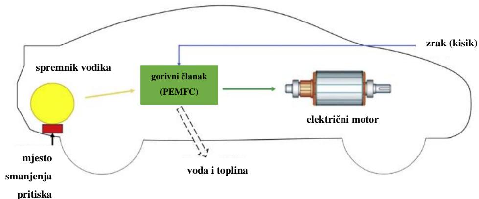
Slika 16. Načelna unutarnja struktura automobila s vodikovim pogonom [13]
