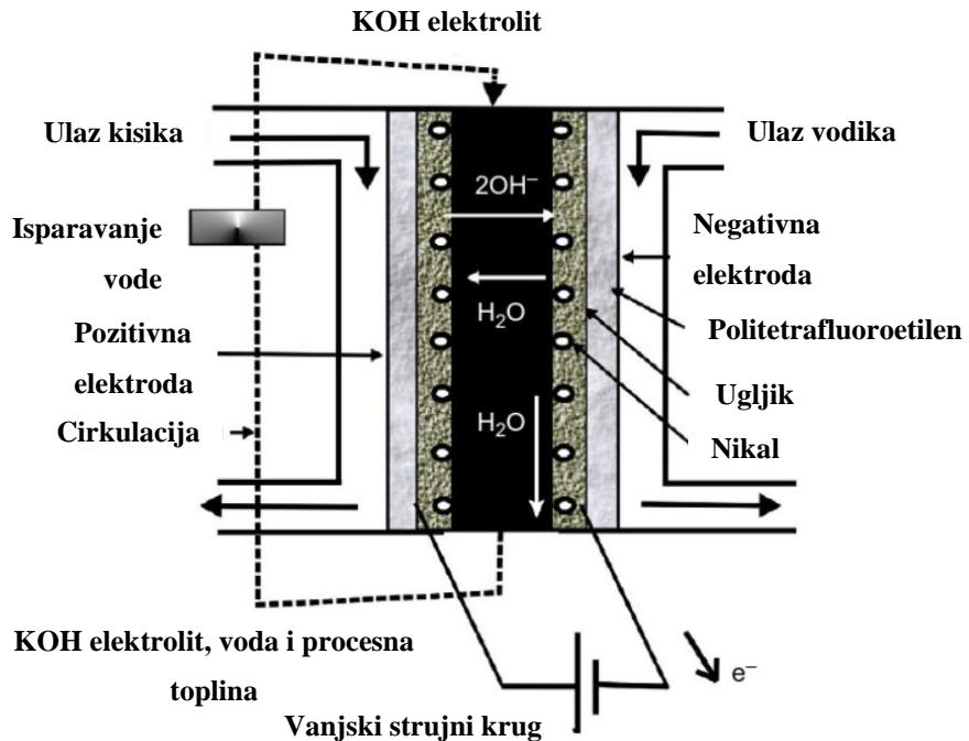
Slika 10. Shematski prikaz alkalinog gorivnog članka [16]
