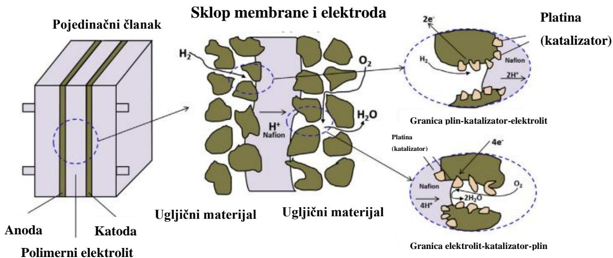
Slika 9. Detaljna struktura PEMFC/PEFC [13]
