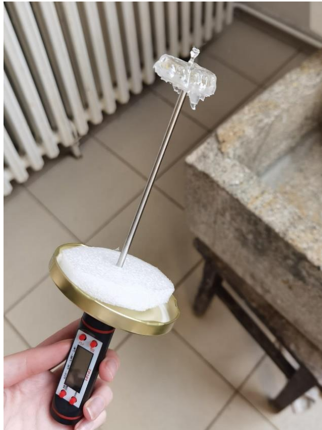
Slika 17. Očvrsnuta smola oko termometra
