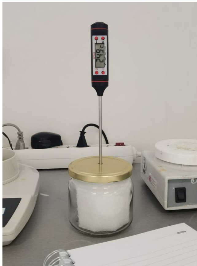
Slika 10. Mjerenje temperature uzorka u izoliranom sustavu
