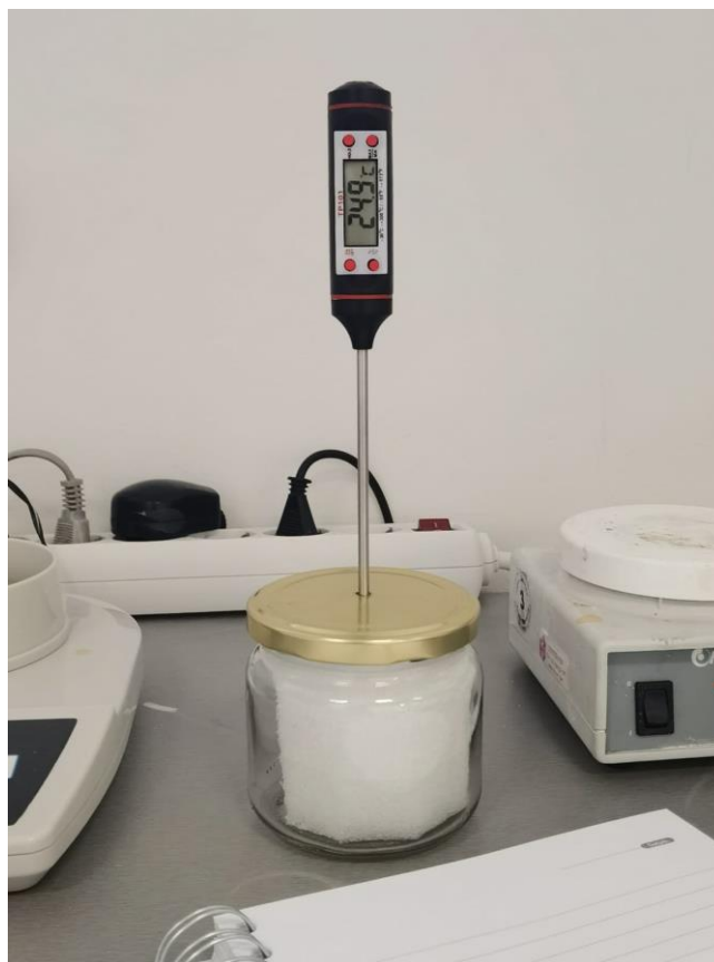
Slika 10. Mjerenje temperature uzorka u izoliranom sustavu
