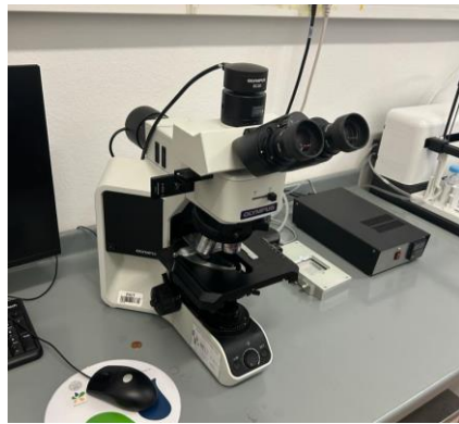
Slika 15. Optički mikroskop s polarizacijom Olympus BX53M.
