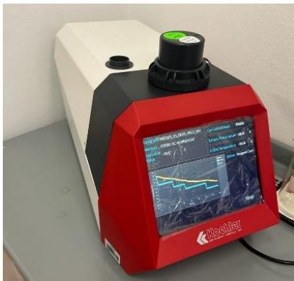
Slika 16. Uređaj za određivanje točke tečenja Koehler K77000.
