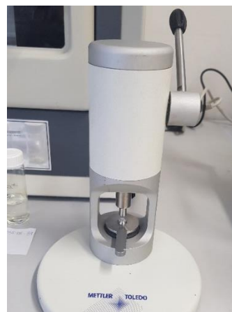
Slika 14. Preša za prešanje aluminijskih lađica za DSC mjerenje.
