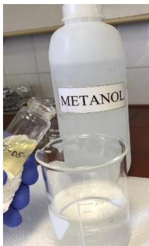
Slika 8. Proces pretaloživanja polimera u metanolu.
