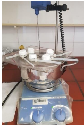
Slika 7. Aparatura za sintezu polimernog aditiva.
