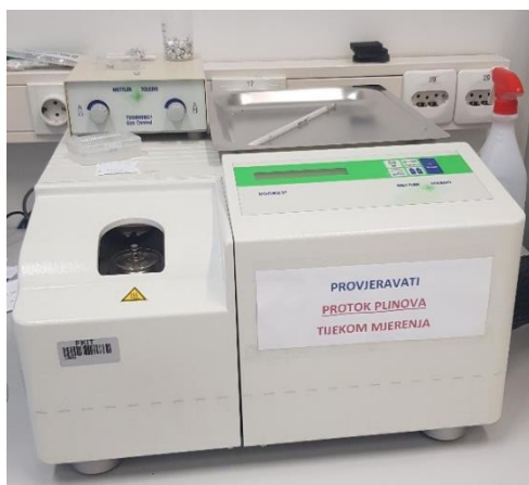
Slika 13. DSC823 MettlerToledo uređaj.
