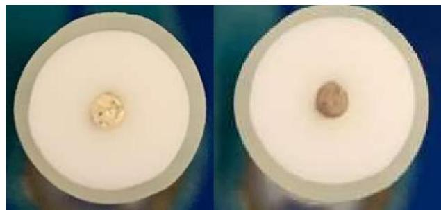
Slika 5. Prikaz srebrne(Ag) elektrode prije i nakon kloriranja.
