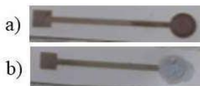
Slika 8. a) Prikaz ispisane Ag-elektrode nakon kemijskog kloriranja; b) prikaz ispisane Ag-elektrode na koju je nanescna RM2.
