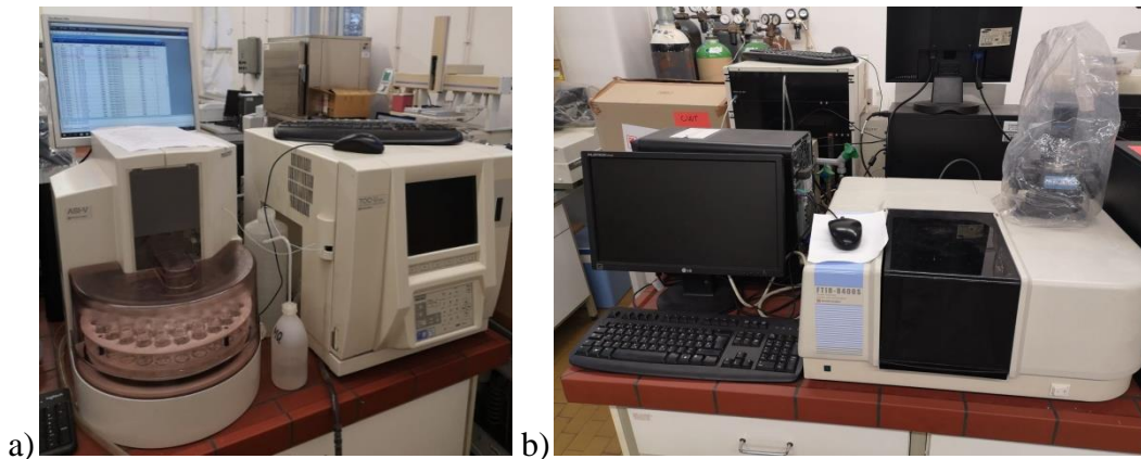
Slika 3.3. Uređaji korišteni TOC-V, Shimadzu a) i FTIR-ATR spektrometar b)
