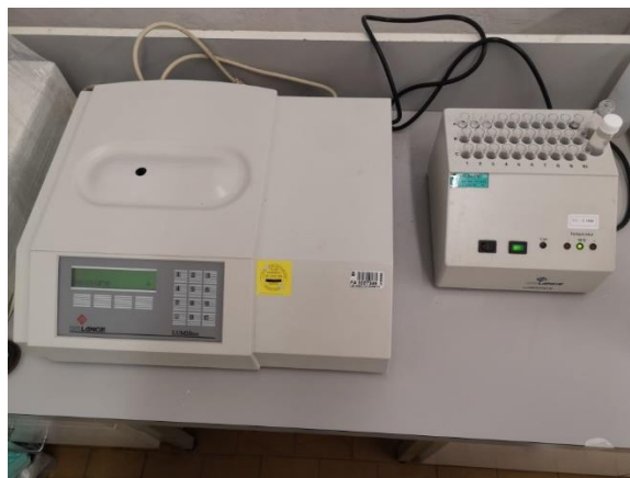
Slika 3.4. Luminometar LUMISTox 300 i termometar LUMIStherm, Hach-Lange Gmb
