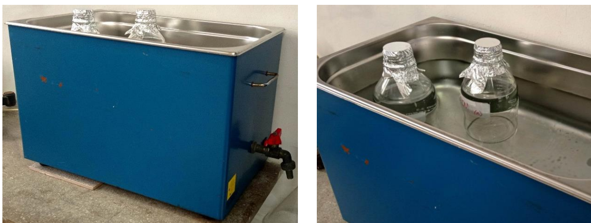
Slika 18. Ultrazvučna kupelj 20R, Iskra, Slovenija
