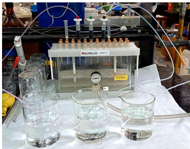
Slika 19. Supelco Visiprep™ 24 aparatura za ekstrakciju čvrstom fazom
