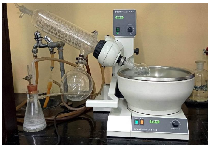
Slika 20. Rotacijski uparivač otapala R-114, Büchi, Švicarska
